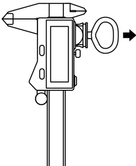
**Bruk det medfølgende verktøyet til å åpne batterirommet og sette inn et batteri.**
