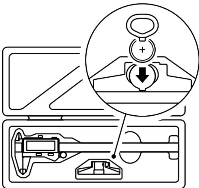
**Bruk oppbevaringsrommet under dybdeanlegget til å oppbevare batteriverktøy og reservebatteri.**
