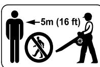
À part l'utilisateur, personne ne doit se trouver dans un rayon de 5 m de la machine en marche – **risque de blessure par des objets projetés !**
