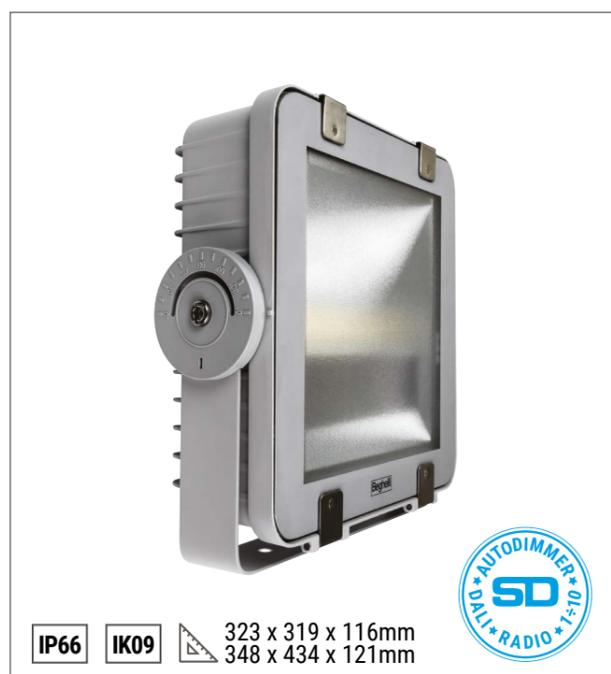
Proiettore con fascio simmetrico/asimmetrico. Disponibile in versione SD Autodimmerabile o con sistema RD dotato di selettore per impostare la potenza dei LED su 4 classi di flusso luminoso. Cablaggio e selettore sono facilmente accessibili aprendo lo schermo basculante che resta solidale al gruppo ottico. Orientamento con staffa goniometrica.
