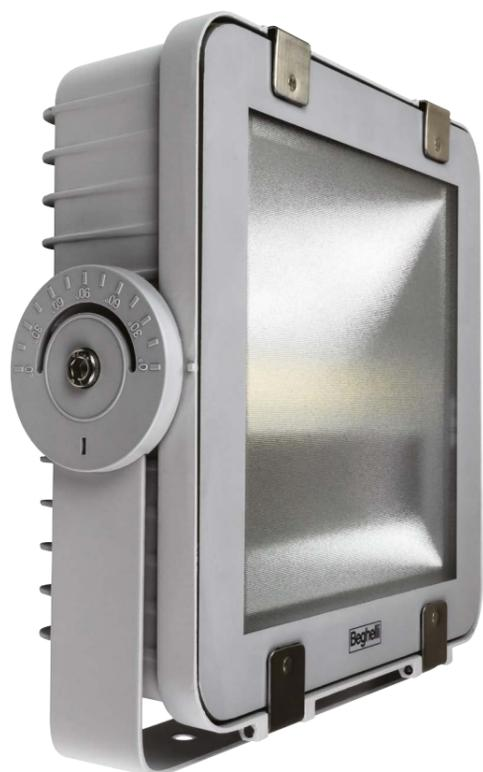
Il nuovo alimentatore autodimmerabile Smart Driver (SD) è dotato di sistema radio per il controllo remoto tramite Centrale SD-Logica. La versione con Driver Regolabile (RD) integra una nuova elettronica dotata di selettore, accessibile comodamente sollevando lo schermo, per regolare la potenza e quindi il flusso luminoso su 4 step. Il riflettore modulare è invece composto da una doppia parabola che proietta un fascio asimmetrico oppure simmetrico, asportando il secondo riflettore.
