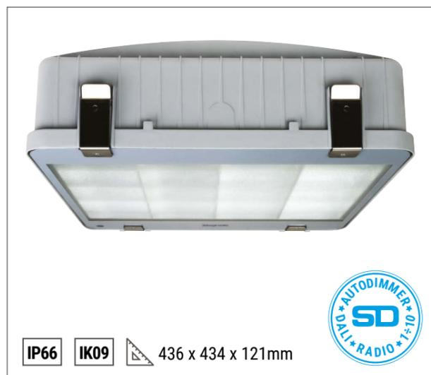
Flusso luminoso fino a 34500 lm, dotato di gongolare per la sospensione. Disponibile in versione SD Autodimmerabile, con Driver intelligente controllabile da Centrale, o con sistema ED dotato di W per impostare la potenza dei LED su 4 classi di flusso luminoso. Cablaggio e kit di regolazione sono facilmente accessibili aprendo lo schermo basculante che resta solidale al gruppo ottico.
