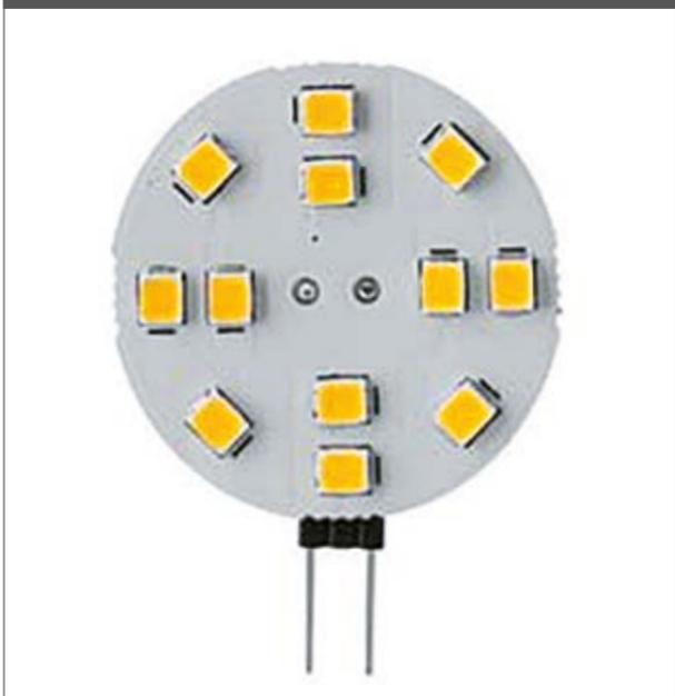
Lampade con attacco G4 con fotodiodi installati su disco piano per applicazioni particolari in 12V, come cappe aspiranti o corpi illuminanti di ridotte dimensioni. Utilizzo con trasformatori elettromagnetici 12V AC e alimentatori LED 12V DC, dotate di pin laterale per ottimizzare gli ingombri.
