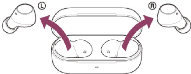
Slušalice sa mikrofonom se pale automatski.
