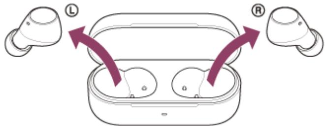
Slušalice sa mikrofonom se pale automatski.
