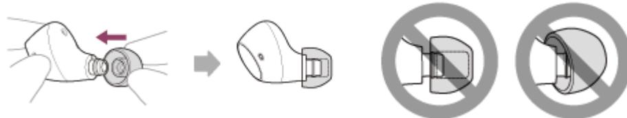
Ako uložak za uši nije u potpunosti pričvršćen, uložak za uši slušalica sa mikrofonom može da spadne sa slušalicama sa mikrofonom smanjujući kvalitet zvuka i trajnost.
