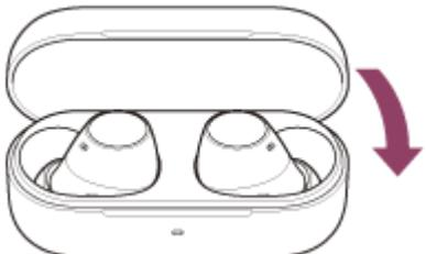
Slušalice sa mikrofonom se isključuju.
