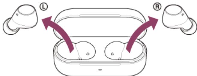
Slušalice sa mikrofonom se pale automatski.
