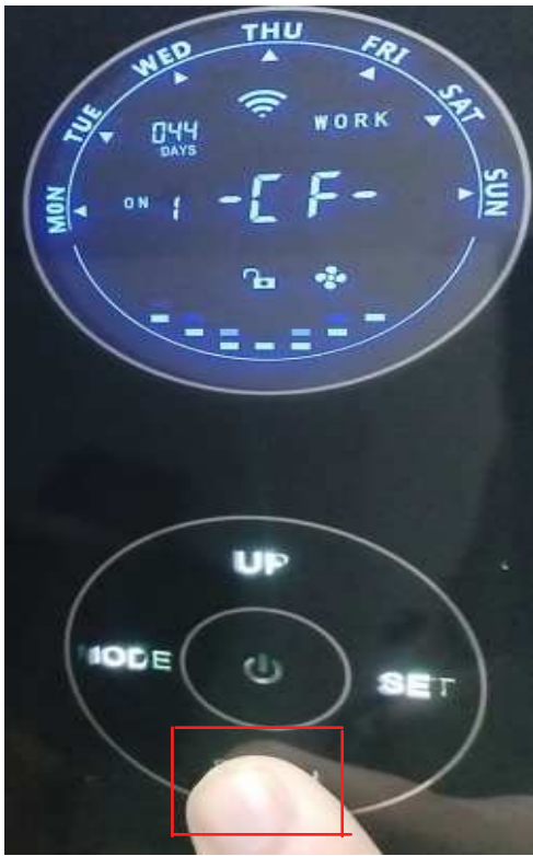
I. Press DOWN button 5 seconds till "-OF -" shown on display ( photos 9 )
