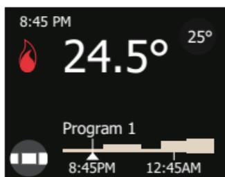
Dans cet exemple, la température de consigne est de 25° et la température mesurée, de 24,5°. Le thermostat active le chauffage par le sol.
