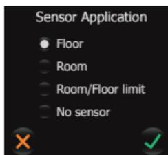
Le thermostat SENZ WIFI peut fonctionner dans les modes de détection de la température suivants :
