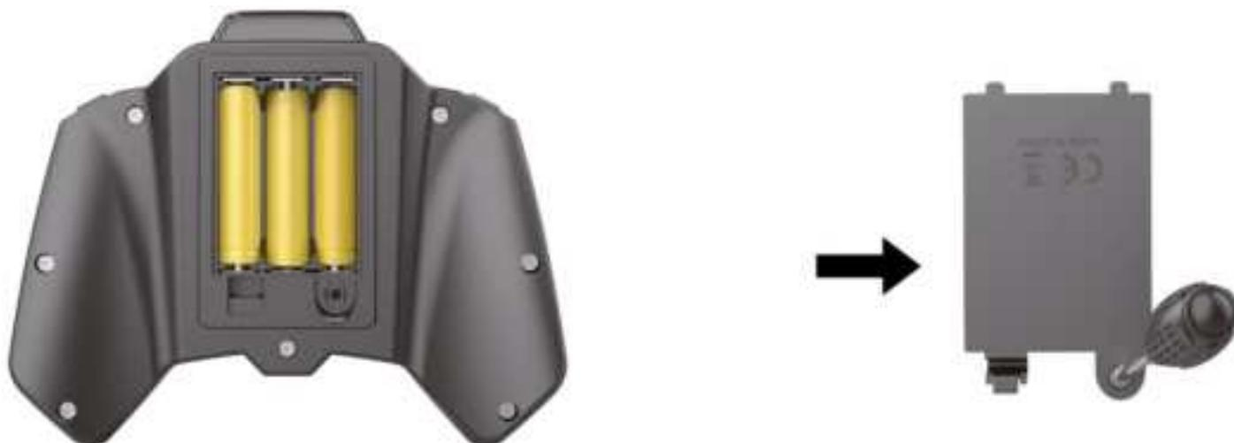
Öffnen Sie die Batteriefachabdeckung und legen Sie drei AAA-Batterien ein. Achten Sie dabei auf korrekte Polarität. Schließen Sie das Batteriefach und sichern Sie die Abdeckung mit der Schraube.
