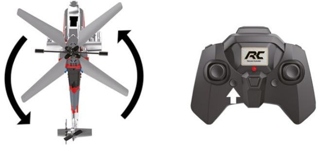
Wenn der Helikopter automatisch nach rechts dreht, drücken Sie die rechte Trimmtaste kontinuierlich, bis der Helikopter gerade in der Luft steht.
