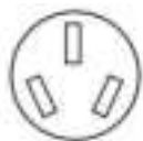
Tomacorriente de 3 hilos (10-50R)
