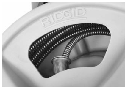
Figura 18 – Enrolle el cable dentro del tambor en la forma que se indica
