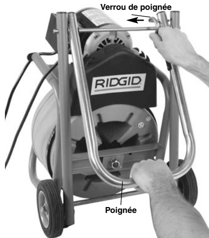
Figure 9 – Déploiement de la poignée
