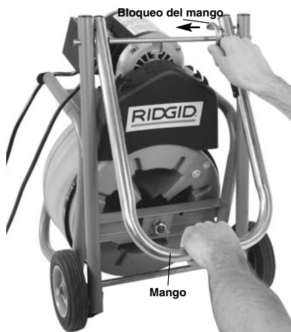
Figura 9 – Operación del mango
