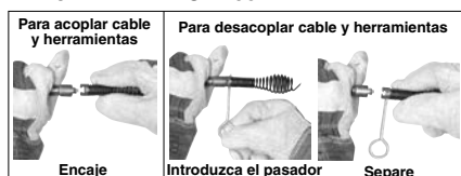
Figura 12 – Acoplamiento y desacoplamiento de herramientas al cable
