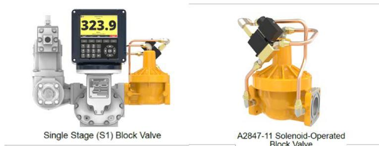
La válvula accionada por solenoide de 3 vías se encuentra en el punto de encuentro de dos líneas desde el eliminador de vapor (una para el vapor eliminado y otra que conduce a la línea de retorno de vapor) y una tubería hacia la parte superior de la válvula de bloqueo. Las válvulas operadas por solenoide de 3 vías generalmente se especifican para productos que retienen vapor en la línea, como LPG y NH3.
