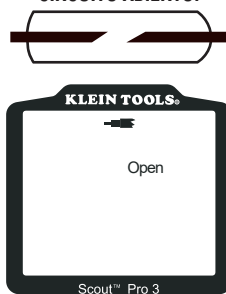
CABLE COAXIAL EN CIRCUITO ABIERTO:
