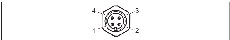
Рис. 24: Расположение штыр. выводов, 4-конт.
