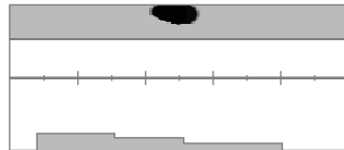
Wird dieselbe dicke verrostete Eisenschraube aus einer anderen Richtung geprüft, zeigt sich der Eisenhalt deutlicher.
