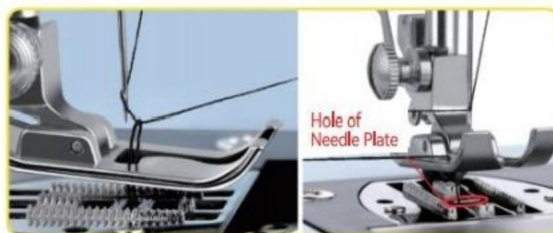
4. Tirez sur le fil supérieur jusqu'à ce que vous voyiez que le fil inférieur est tiré hors du trou de la plaque à aiguille avec fil supérieur Retirez ensuite le fil inférieur pour le séparer du fil supérieur.
