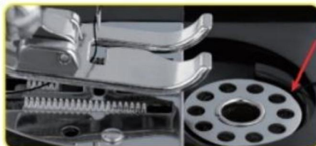
2. Placez la canette inférieure et tirez le fil sur environ 4 pouces de long. (Assurez-vous que la longueur du fil est supérieure à 4 pouces avant d'enfiler, sinon le filetage est difficile à trouver.)
