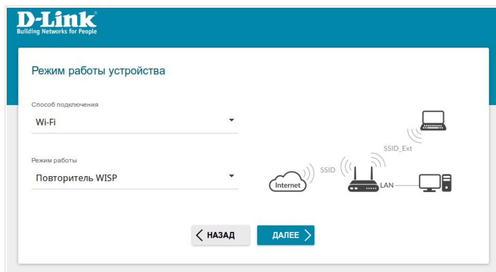
Рисунок 24. Выбор режима работы устройства. Режим Повторитель WISP .
