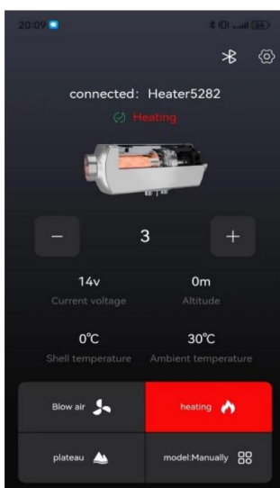
Einschaltstatus (manueller Modus)
