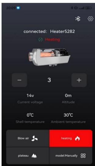
État de mise sous tension (mode manuel)
