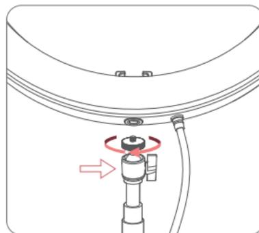
2. Coloque el "adaptador de cabezal esférico" en la parte superior del soporte de la luz. Inserte el tornillo de 1/4" del cabezal esférico en el orificio de montaje en la parte inferior del aro de luz y luego gírelo en el sentido de las agujas del reloj hasta que quede bien apretado.
