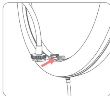
1. Inserte el tubo flexible en la zapata de montaje en frío de la luz.
