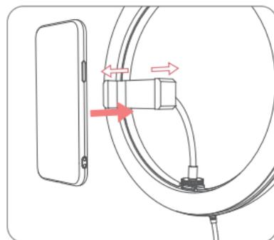
3. Estire ambos extremos del soporte para teléfono para que se ajuste a teléfonos de distintos tamaños.
