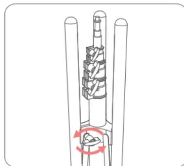
1. Afloje la "perilla de bloqueo" girándola en sentido contrario a las agujas del reloj, extienda las patas hacia afuera y ajuste su ángulo. Una vez que esté ajustado, ajústelo girando la perilla en el sentido de las agujas del reloj.
