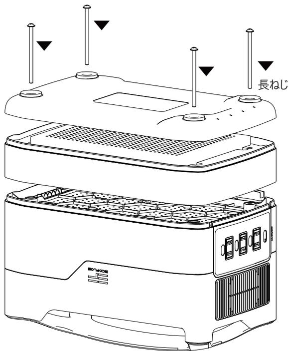
3. エキストラバッテリーをメスポートが本体のオスポートに接続されるように設置し、底蓋を閉め、長ねじ 4本を締めて固定してください。
