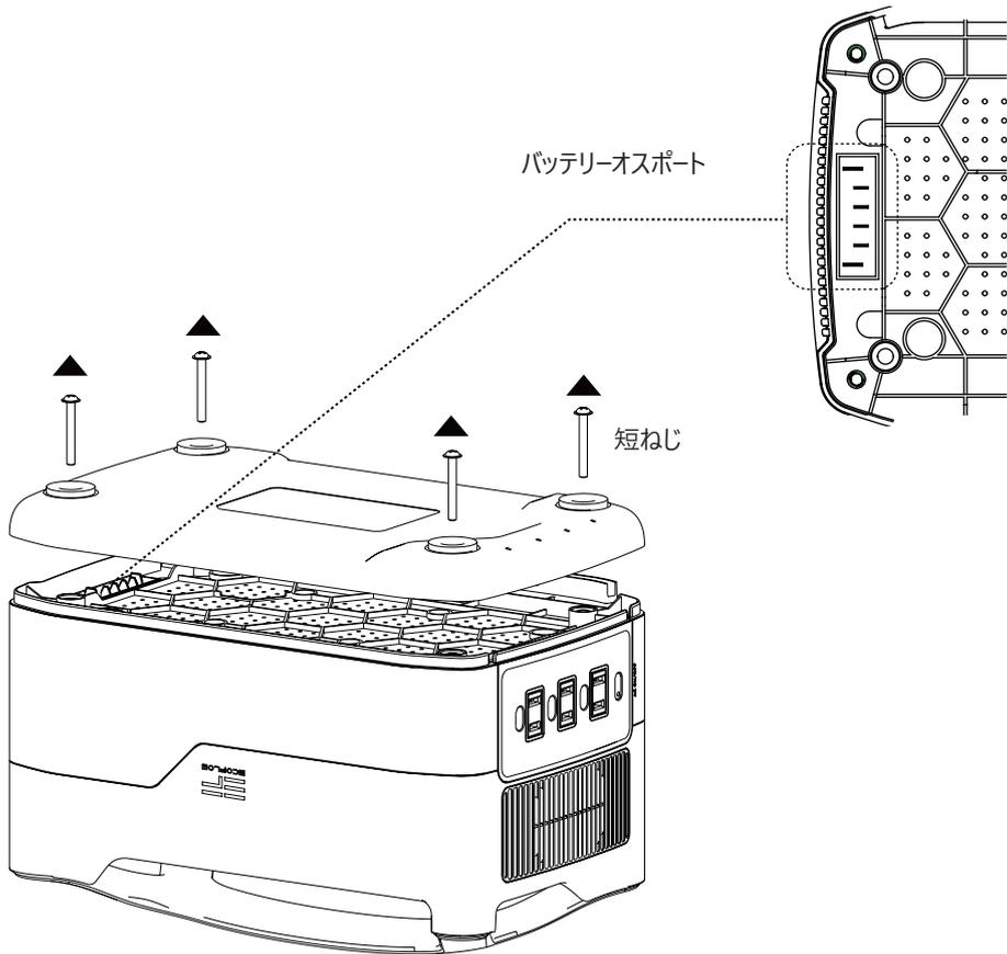
2. 図のように、ねじ4本を取り外して底蓋を開けると、バッテリーオスポートが見えます。エクストラバッテリーを接続するのはこの部分です（底蓋だけを開けてください。上部の蓋を開ける必要はありません）。
