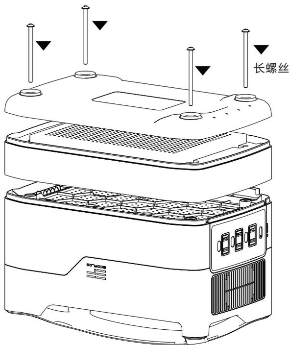
3.将加电包公座对准母座，插接在主机上，然后盖上盖子，再将包装中四枚长螺丝取出，装在螺丝孔中进行固定。
