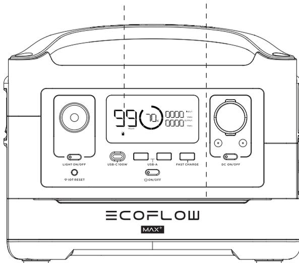
4. 本体を正面向きに戻して、電源をオンにします。エクストラバッテリーのムードライトエリアの青色ライトがBreathモードで点灯し、本体のディスプレイにバッテリー合体インジケータが表示されたら、取り付け完了です。必ず本体をフル充電してから使用してください。もし上記のライトやインジケータが点灯、表示されない場合は、ステップ 2 からやり直してください。
