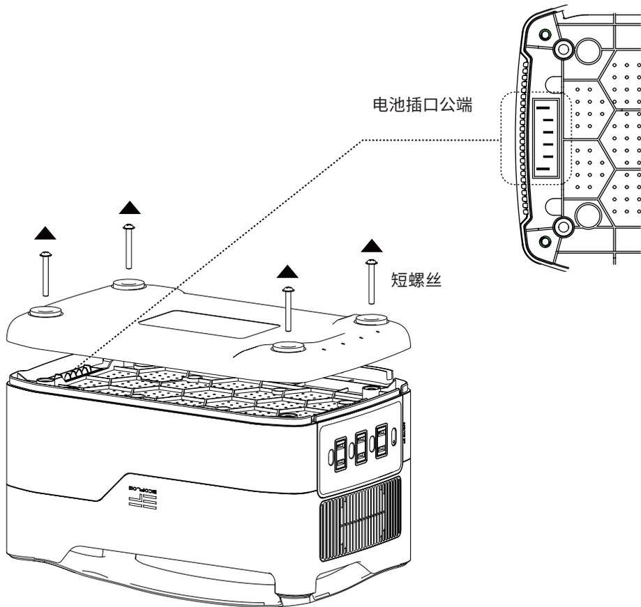
2.按照图示将四个螺丝进行解除,然后将底部盖子取出,您就可以看到电池插座的公端,加电包的对接位置就如图所示。(注意只需要将底部盖子取出,顶部的盖子不需要拆卸)
