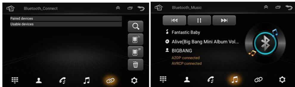
Toque el icono de Bluetooth para acceder a esta página. Abra la opción Bluetooth en el teléfono móvil y busque el dispositivo llamado "BT Car". El código PIN es "0000". Los usuarios también pueden acceder a la configuración para cambiar la etiqueta y el código PIN del dispositivo bluetooth.
