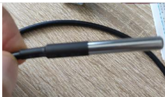
Figure 5 : Une sonde DS18B20 étanche
