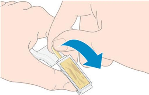
12. Retire la esponja usada del limpiador de conexiones del carro.
