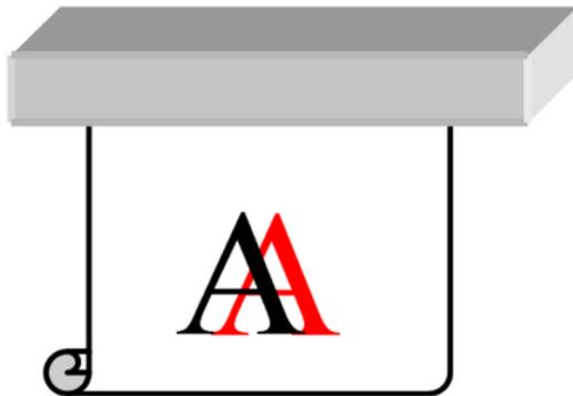
Los cabezales de impresión pueden estar desalineados si no los ha alineado desde hace mucho tiempo o se ha producido un atasco de sustrato. Alinee los cabezales de impresión si es necesario (consulte [Alineación de los cabezales de impresión en la página 188](#)). Puede comprobar si es necesario imprimiendo el trazado de estado de los cabezales de impresión (consulte [Trazado del estado de alineación en la página 154](#)).
