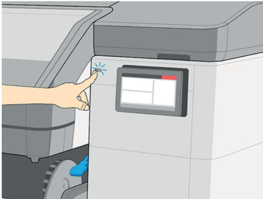
Al apagar la impresora de esta forma, se evita que los cabezales de impresión se sequen, ya que éstos se almacenan automáticamente con el cartucho de mantenimiento.
