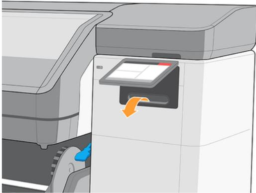
4. Levante el módulo de curado y mueva el carro hacia el centro de la zona de impresión.
