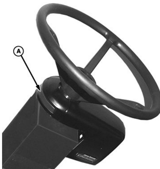
A—Interruttore di ripresa
