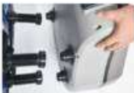
11. Pripojte čerpadlo k bazénu pomocou 3 skrutkovacích spojok. Zaistíte, aby ikony na čerpadle a bazéne boli zarovnané.
