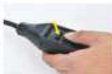
Stlačte tlačidlo „TEST“, kontrolka zhasne
