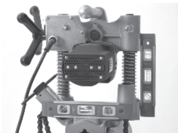
Figura 10 – Nivelación de la HC-300
