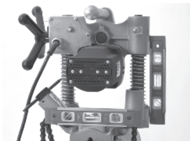
Figure 10 – Mise de niveau de la HC-300
