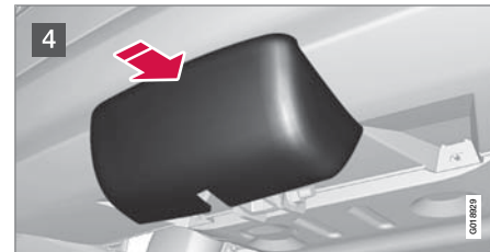
4 Työntäkää suojakoteloä paikalleen, kun- nes se tarttuu kiinni.
