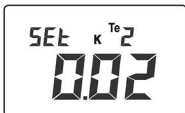
1. Usare i tasti freccia **▲** e **▼** per impostare il valore corretto del K (Sensitivity) riportato sull'etichetta (frontale o posteriore) posta sul sensore stesso
