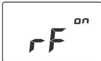
Abilitare la comunicazione RF tenendo premuto premuto il tasto **FUNC/▲** mentre si accende lo strumento con il tasto **⏻/ESC**. Il messaggio "rF<sup>ON</sup>" appare a display per alcuni secondi. Nel caso appaia il messaggio "rF<sup>OFF</sup>" spegnere lo strumento e ripetere l'operazione. Successivamente lo strumento presenta la normale videata iniziale. L'impostazione del parametro "RF" sarà mantenuto anche in caso di sostituzione delle batterie
