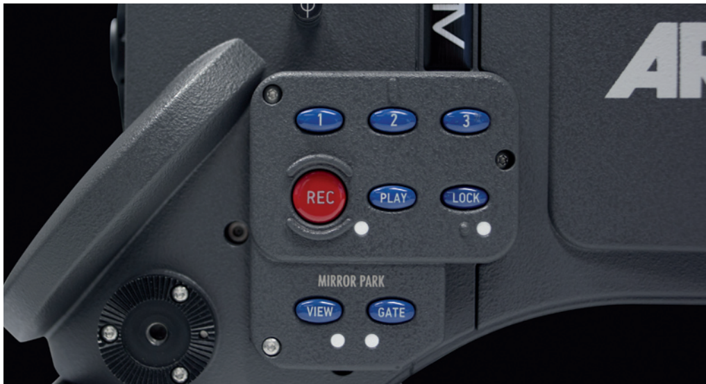
ALEXA Studio机身左侧。相比其他机型，多出了用于反光镜控制的VIEW（取景）和GATE（片门）按钮。
