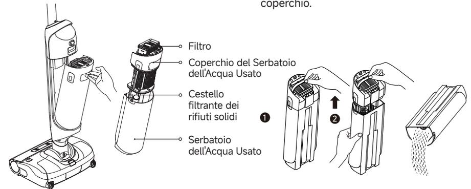
3. Risciacquare il serbatoio dell'acqua usata e il coperchio del serbatoio con acqua. Utilizzare la spazzola di pulizia in dotazione per pulire le pareti interne del serbatoio.
