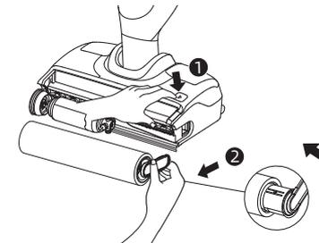
3. Eliminare i capelli e i detriti incastrati nella spazzola a rullo con la spazzola di pulizia in dotazione. Sciacquare la spazzola a rullo e il coperchio con acqua pulita e farli asciugare completamente.
