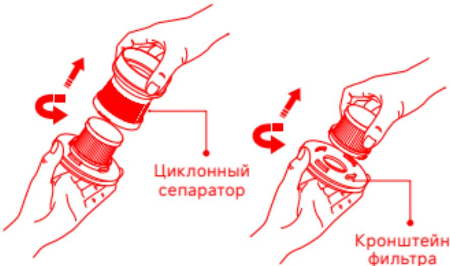
3. Поверните новый фильтр по часовой стрелке на кронштейне фильтра, чтобы установить его.
