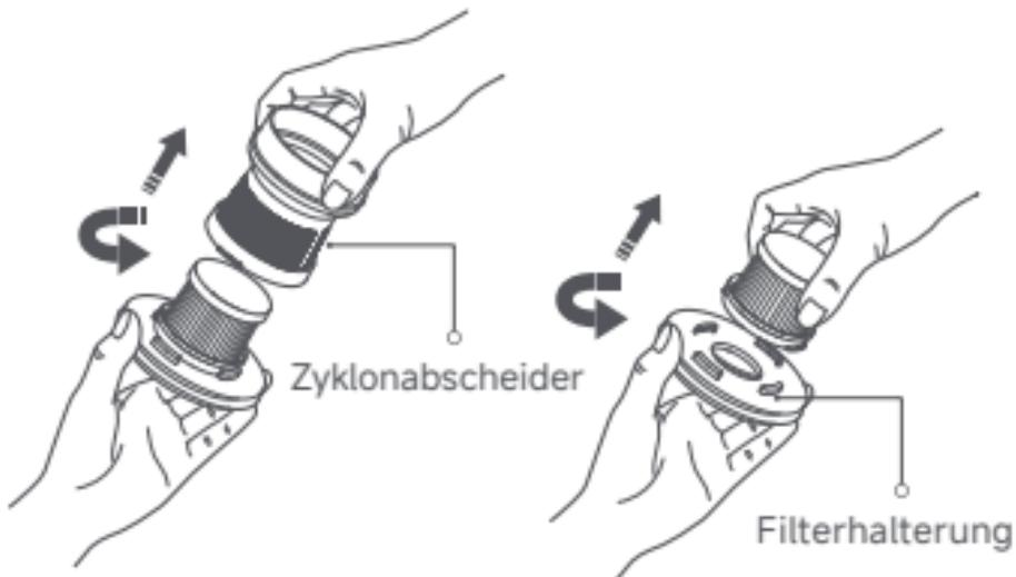
3. Drehen Sie den neuen Filter im Uhrzeigersinn auf die Filterhalterung, um ihn zu installieren.
