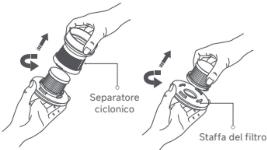
3. Ruotare il nuovo filtro in senso orario sulla staffa del filtro per installarlo.
