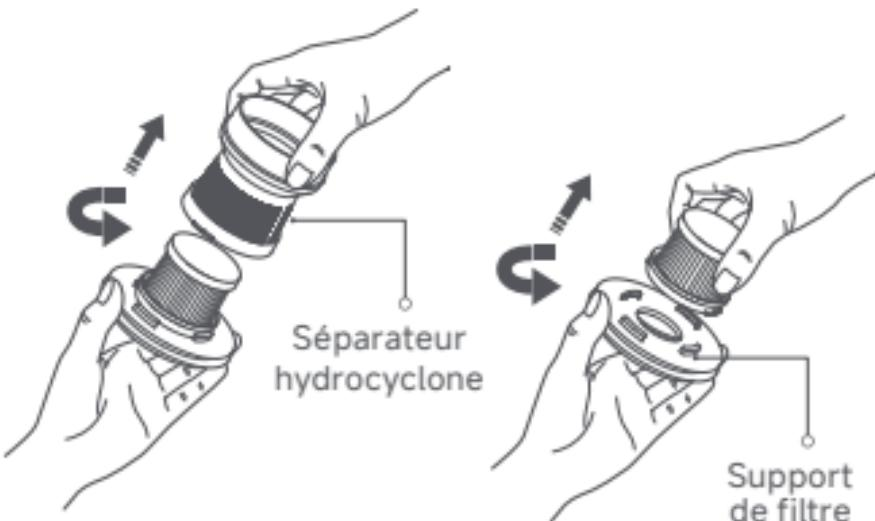
3. Tournez le nouveau filtre dans le sens des aiguilles d'une montre sur le support de filtre pour l'installer.
