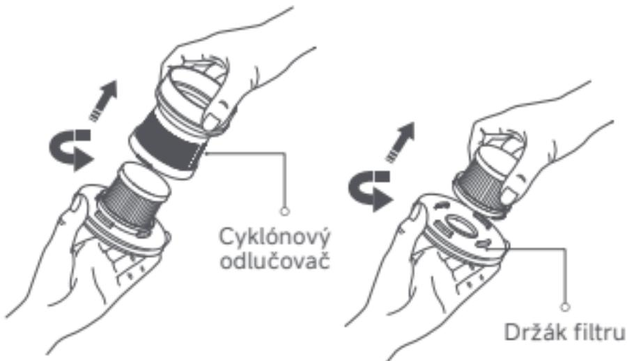
3. Otočením nového filtru ve směru hodinových ručiček jej namontujte na držák filtru.
