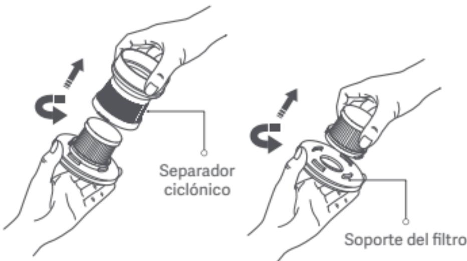
3. Gire el nuevo filtro en sentido horario sobre el soporte del filtro para instalarlo.
