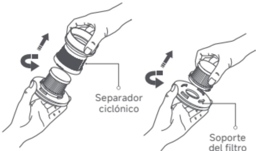
3. Gire el nuevo filtro en el sentido de las agujas del reloj sobre el soporte del filtro para instalarlo.
