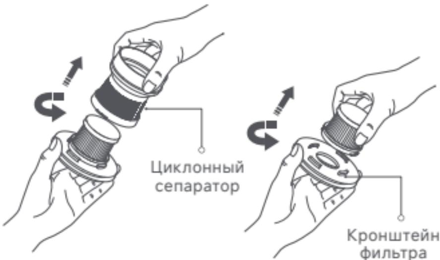
3. Поверните новый фильтр по часовой стрелке на кронштейне фильтра, чтобы установить его.
