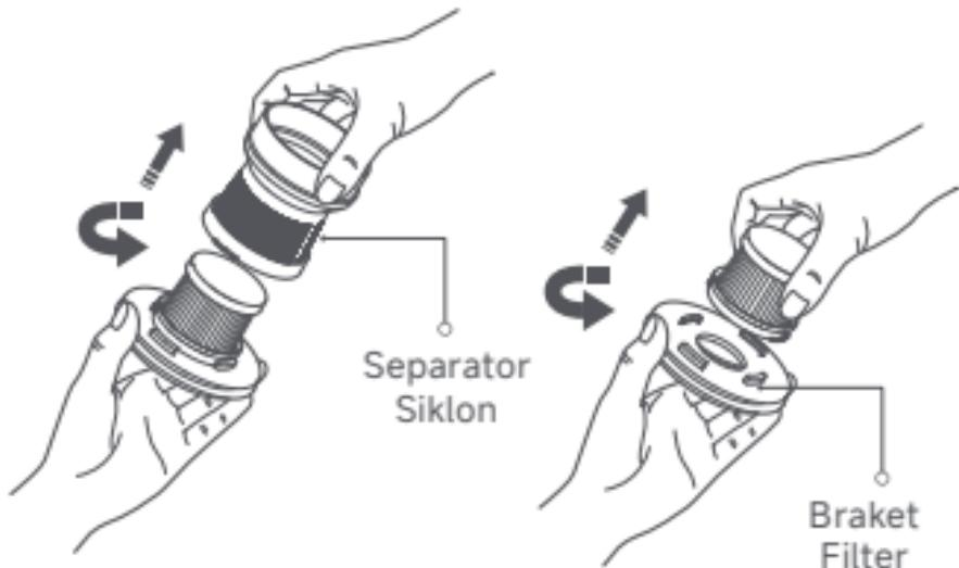
3. Putar filter baru searah jarum jam ke braket filter untuk memasangnya.
