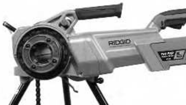
Figura 11 – Corretto orientamento dell'Unità di trasmissione 760 FXP
