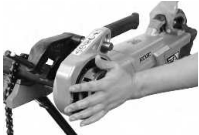
Şekil 13A – Pafta Kafası Kapak Plakasını Kullanarak Dış Açmanın Başlatılması
