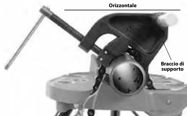
Figura 10A – Posizionamento del braccio di supporto
