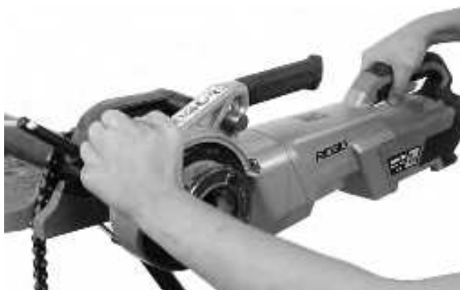
Slika 13B – Započinjanje navoja pomoću podloge za guranje
