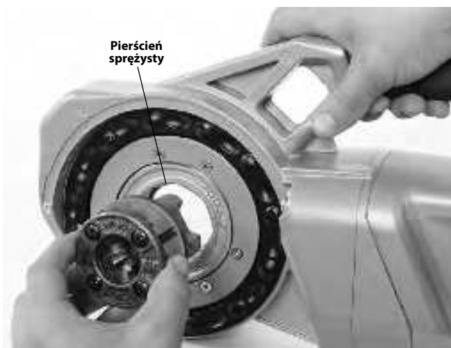
Rysunek 8 - Instalacja głowicy 1 1/4" lub mniejszych 11-R (tylko 760 FXP 11-R)
