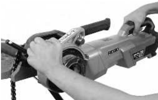
Figur 13B – Starta gängningen med tryckplattan
