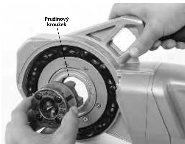
Obrázek 8 – Instalace závitorezných hlav 11-R 1 1/4" nebo menších (pouze 760 FXP 11-R)
