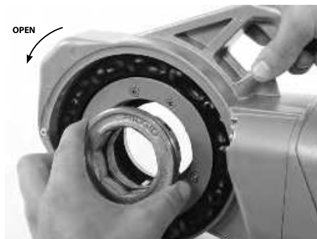
Afbeelding 7 – De adapter monteren
