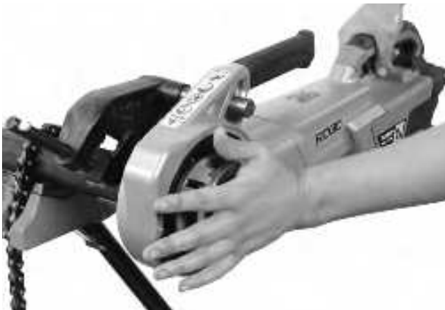
Abbildung 13A - Gewindeschneiden mithilfe der Schneidkopfabdeckplatte starten
