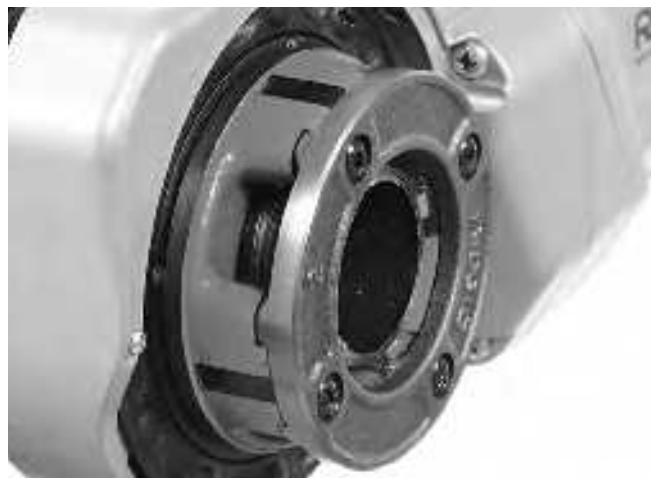
Obrázok 15 – Rúra zarovnaná s hranou závitnice
