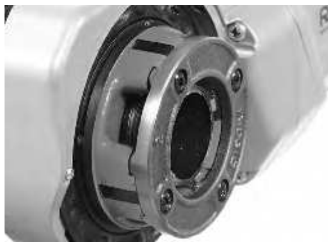
Slika 15 – Cev je poravnana z robom rezalnih nastavkov
