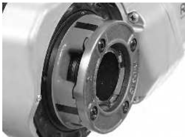
Figur 15 – Röret i linje med gängbackarnas kant
