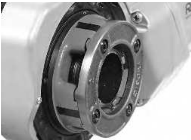
Slika 15 – Cijev poravnata s rubom noževa
