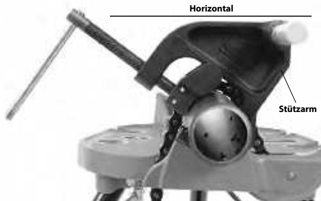
Abbildung 10A - Positionierung des Stützarms
