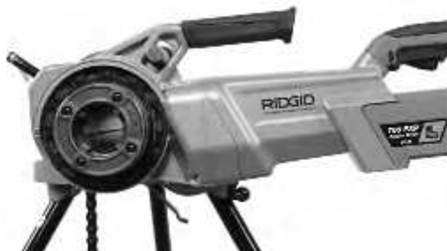
Figur 11 – Korrekt orientering av 760 FXP Power Drive
