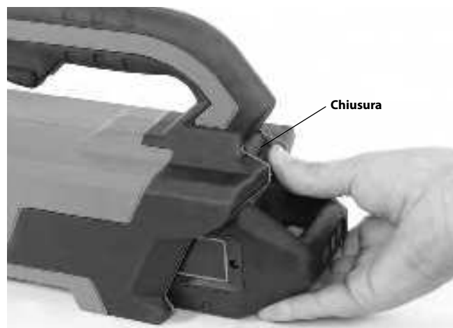
Figura 12 – Serratura a scatto della batteria
