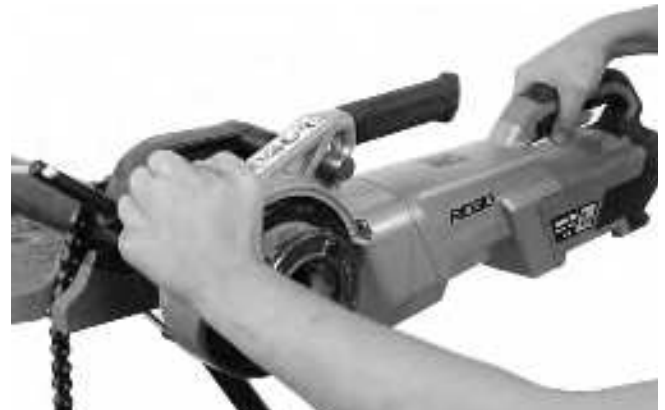
Abbildung 13B - Gewindeschneiden mithilfe des Druckkissens starten
