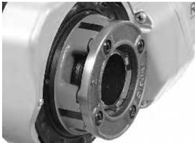
Figur 15 – Rør på linje med kanten av gjengebakkene
