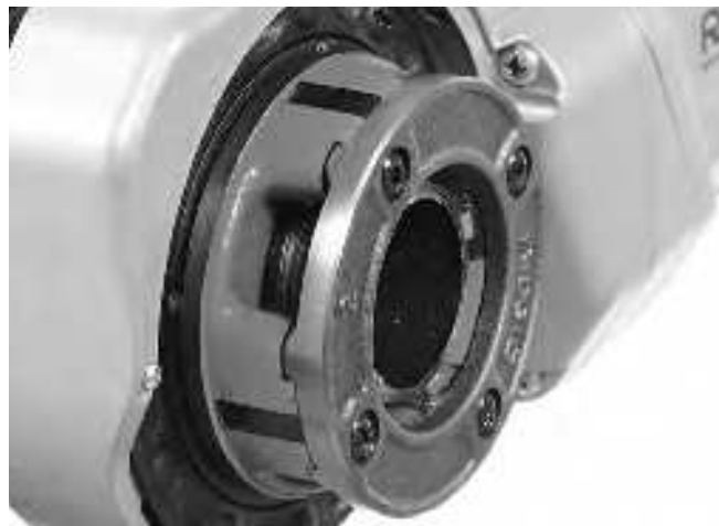
Obrázek 15 – trubka zarovnaná s okrajem řezných matic
