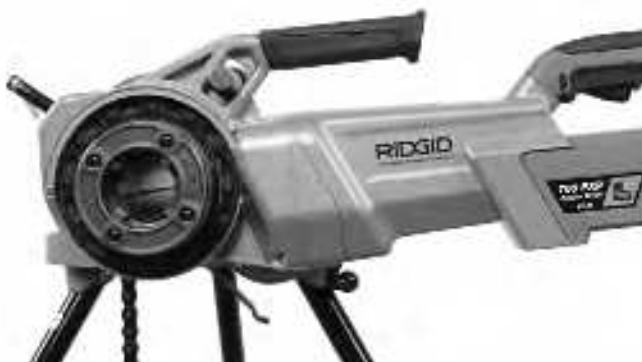
Abbildung 11 - Richtige Ausrichtung des 760 FXP Kraftantriebs
