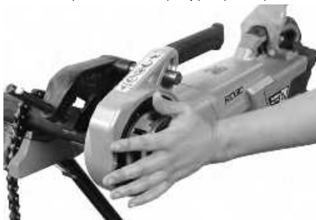
Figura 13A – Pornirea filetării prin utilizarea capacului capului-filieră
