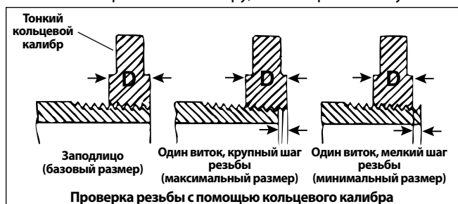
Рис. 16 – Проверка размера резьбы
