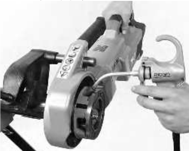
Şekil 14 – Boruya Diş Açılması
