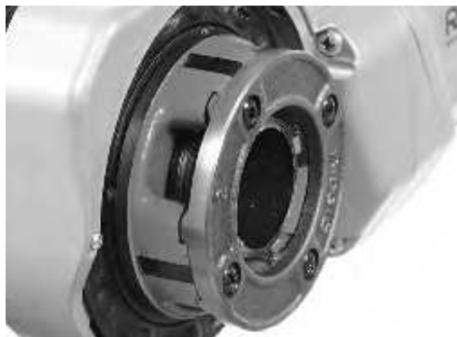
Figur 15 – Rør i niveau med kanten på bakkerne
