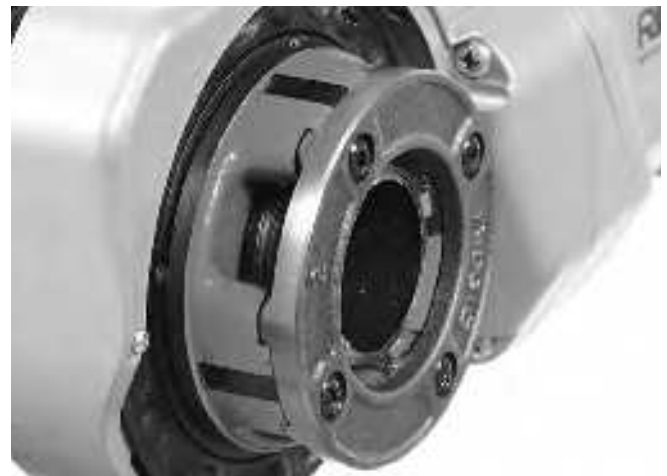
Figura 15 – Tubo allineato al bordo degli stampi
