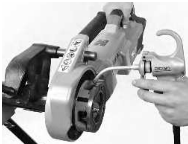
Figura 14 – Roscado de un tubo
