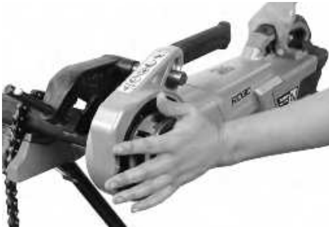
Kuva 13A – Kierteen aloittaminen käyttämällä kierrepään suojalevyä
