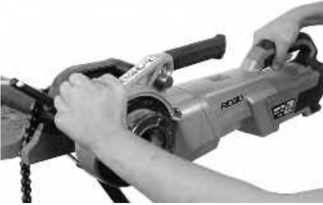
Şekil 13B – İtme Plakası Kullanarak Diş Açmanın Başlatılması
