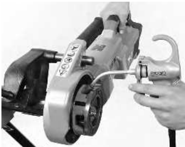
Рис. 14 – Нарезание резьбы на трубе
