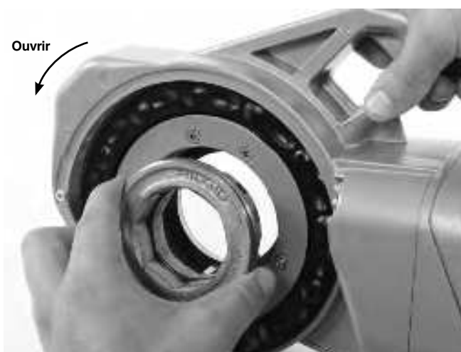
Figure 7 – Installation de l'adaptateur
