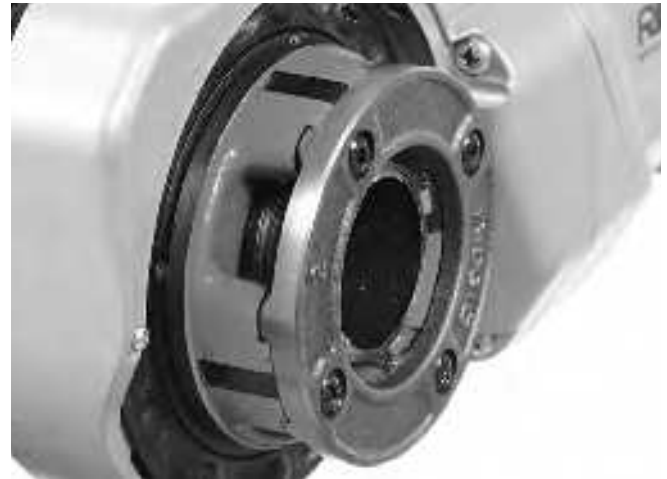
Şekil 15 – Paftanın Kenarıyla Hizalı Boru
