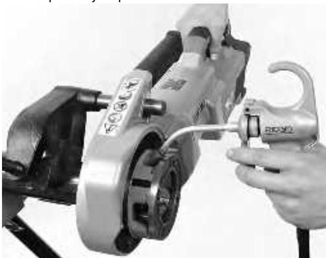
Obrázek 14 – řezání závitu na trubce
