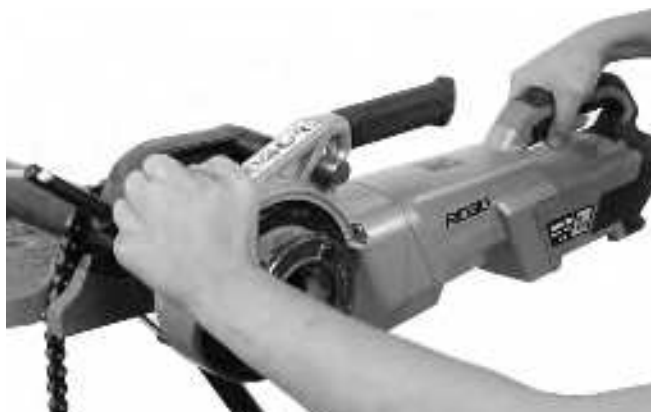
Figura 13B – Pornirea filetării prin utilizarea plăcii de împingere
