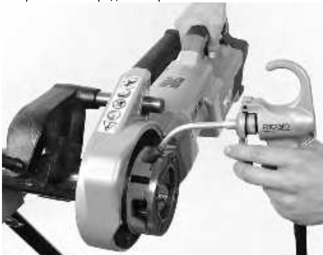
Фигура 14 – Резбоване на тръба
