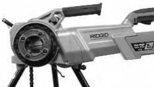
Figura 11 – Orientación correcta del accionamiento motorizado 760 FXP
