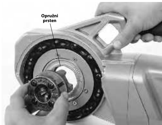
Slika 8 – Montiranje narezni glava 11-R 1¼" ili manje (samo 760 FXP 11-R)
