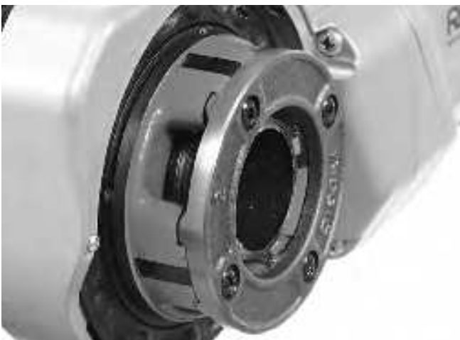
Abbildung 15 – Rohr fluchtet mit Kante der Schneidbacken
