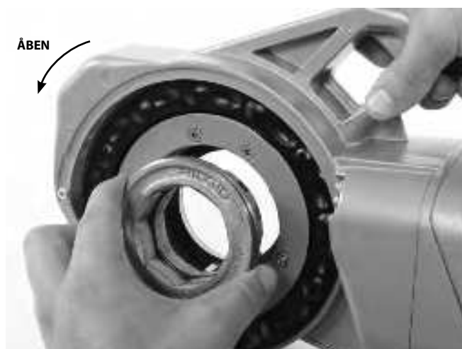
Figur 7 – Montering af adapter
