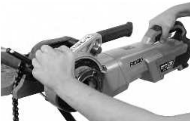
Figur 13B – Starte gjengingen med skyveputen
