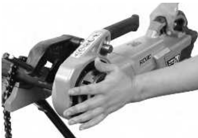
Rysunek 13A - Nacinanie początku gwintu przy użyciu płyty pokryw głowicy gwinciarzkiej
