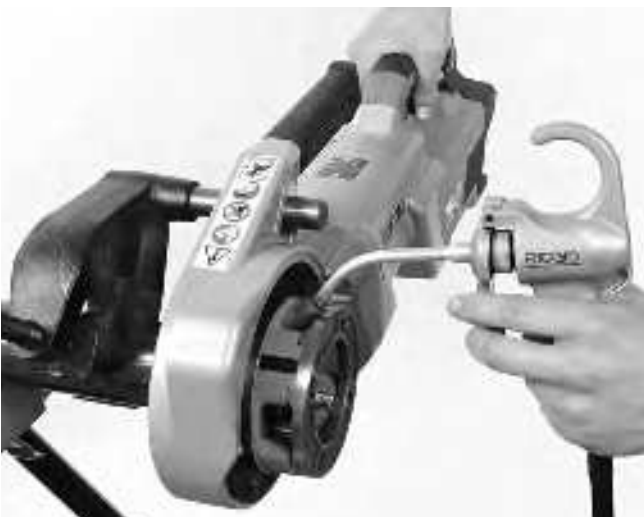
14. ábra – Menetvágás csőre
