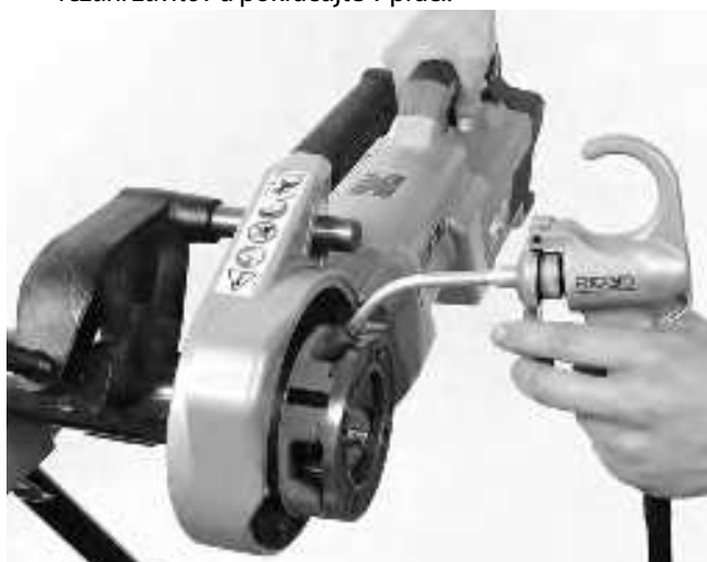
Obrázok 14 – Rezanie závitov na rúru
