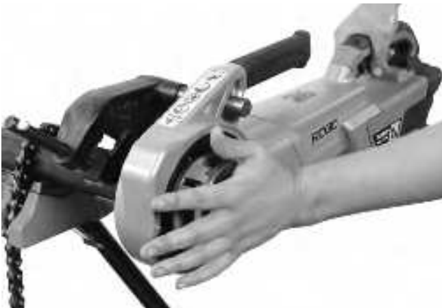
Figur 13A – Starte gjengingen med gjengehodets dekkplate
