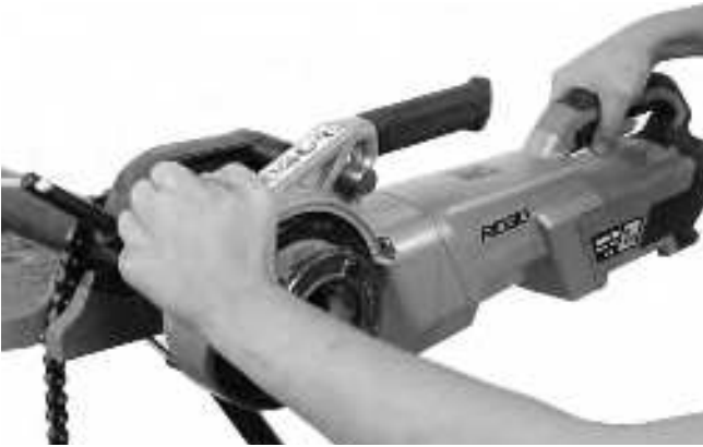
13B ábra – Menetvágás kezdése a nyomópárna használatával
