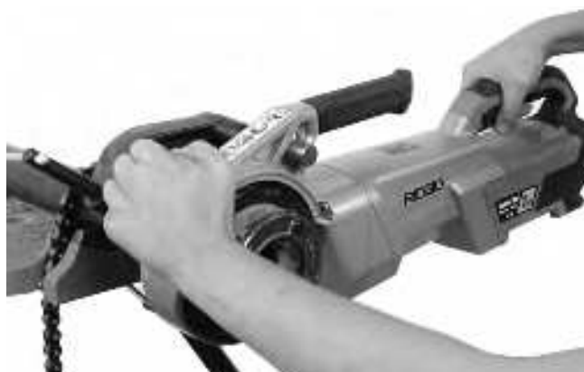
Slika 13B – Pokretanje narezivanja s pomoću pritisne ploče
