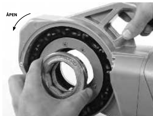
Figur 7 – Montering av adapter
