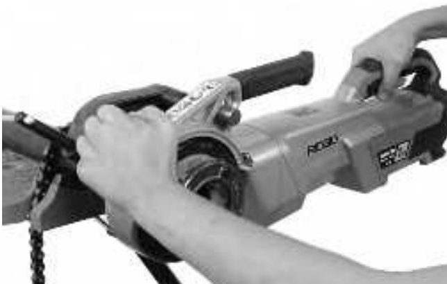
Figura 13B – Avvio filettatura utilizzando il cuscinetto di spinta
