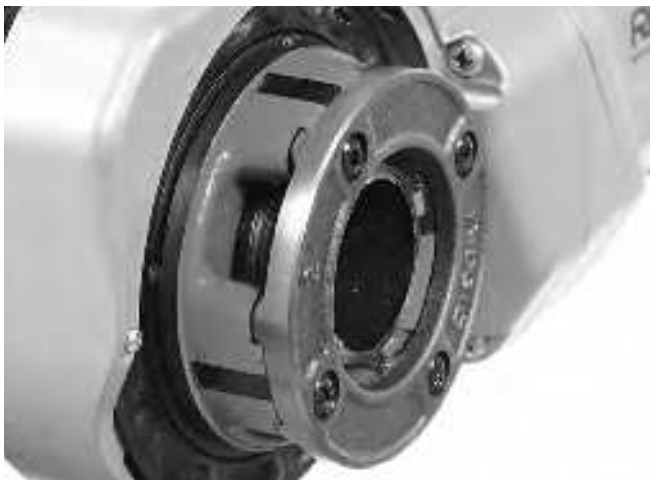
Slika 15 – Cev poravnata sa ivicom nareznice
