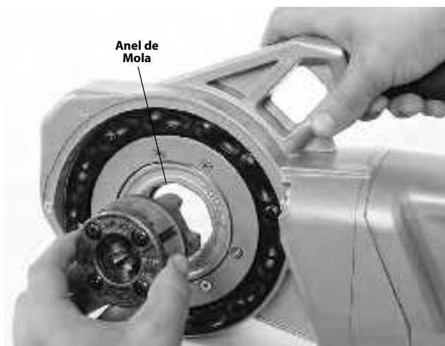
Figura 8 – Instalação de Cabeças de Roscar 1 1/4" ou 11-R mais pequenas (apenas 760 FXP 11-R)
