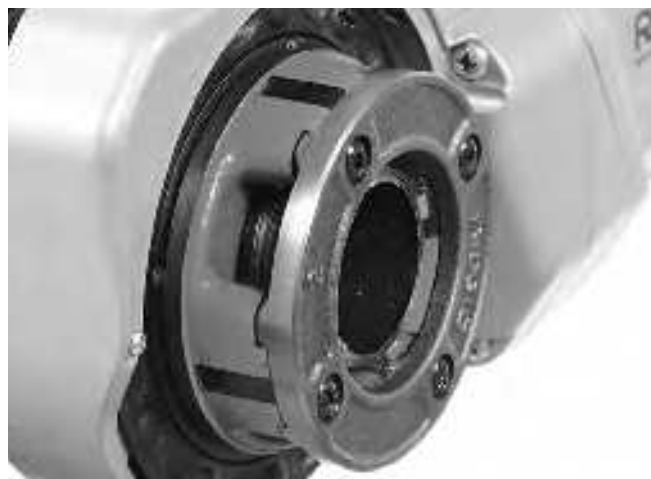
Figura 15 – Țeava la nivel cu marginea filierelor
