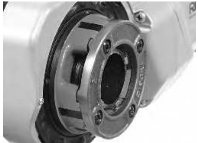
15. ábra – A cső a menetvágók szélével egy síkban van
