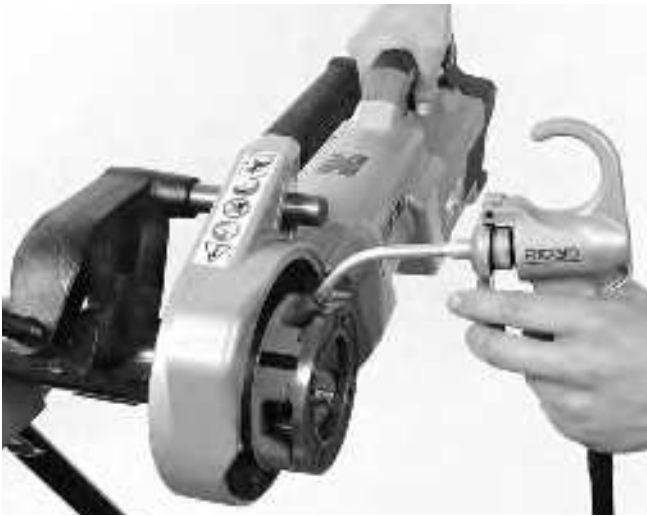
Abbildung 14 – Gewindeschneiden in Rohr
