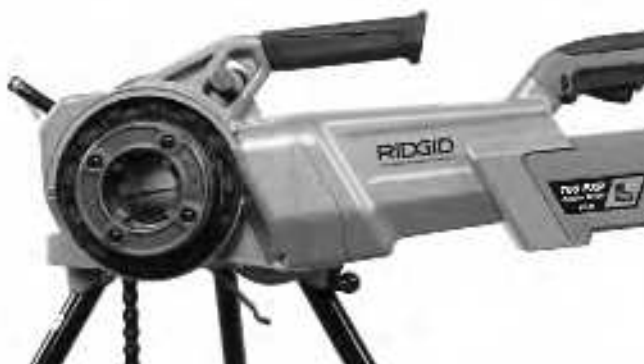
Afbeelding 11 – Juiste richting van de 760 FXP Power Drive
