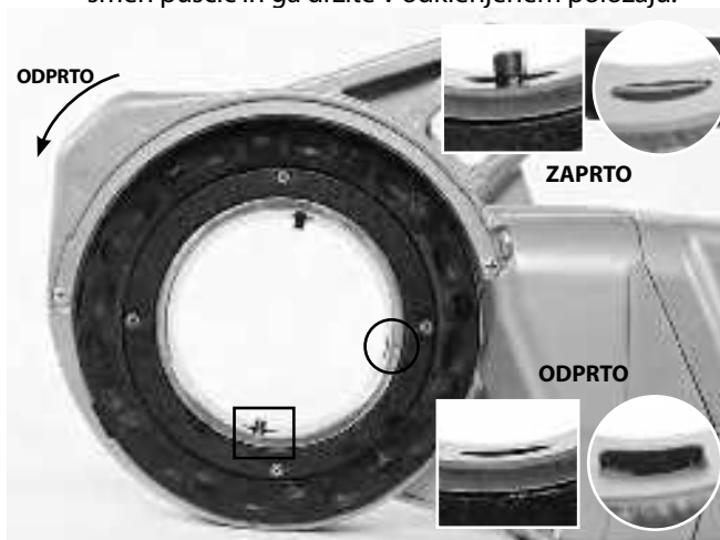
Slika 6A – Zadrževalni mehanizem (760 FXP 12-R)
