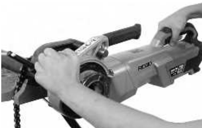
Obrázek 13B – Spuštění řezání závitu pomocí tlačné destičky
