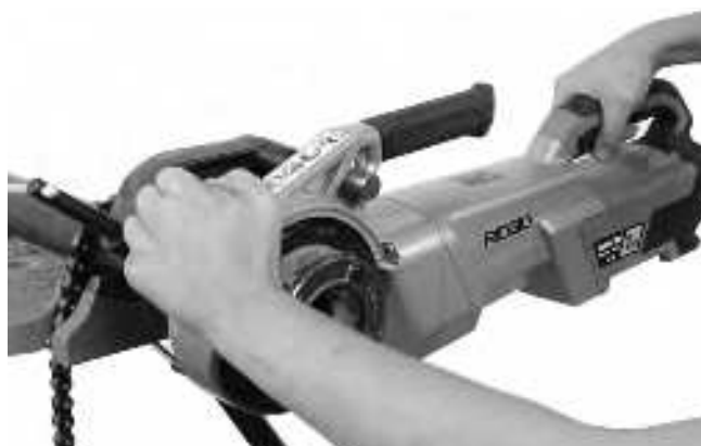
Рис. 13В - Начало нарезания резьбы с помощью нажимной площадки
