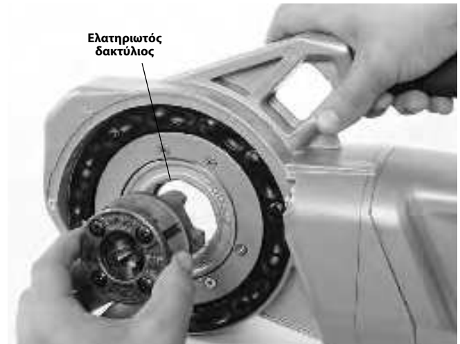
Εικόνα 8 – Εγκατάσταση φιλίδας 11-R για μεγέθη 1 1/4" ή μικρότερα (760 FXP 11-R μόνο)
