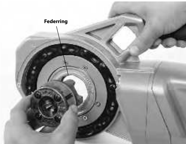
Abbildung 8 – Einbau von 1¼" oder kleineren 11-R Schneidköpfen (nur 760 FXP 11-R)
