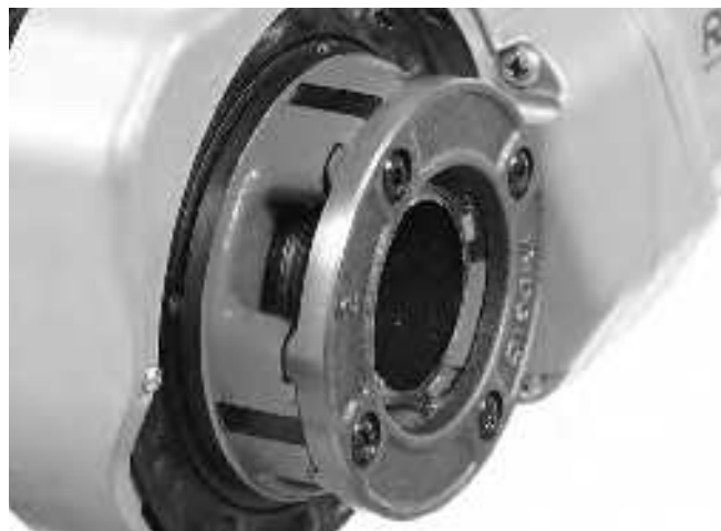
Figura 15 – Tubo alinhado com extremidade das tarra-xas
