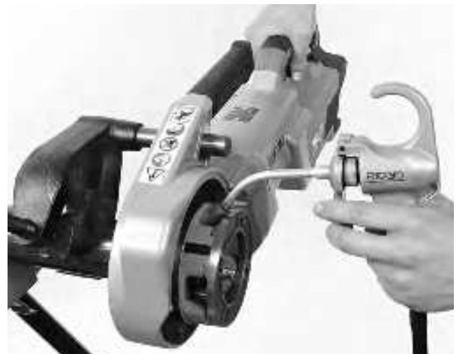
Figura 14 – Filettatura del tubo
