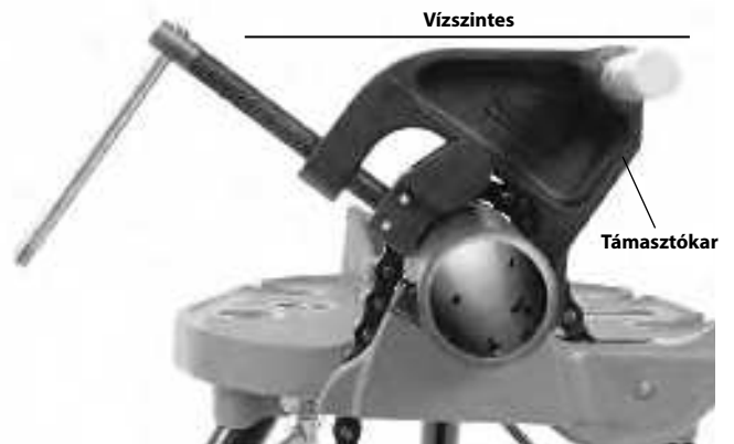
10A ábra – A kitámasztó kar elhelyezése
