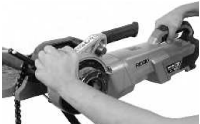
Kuva 13B – Kierteen aloittaminen käyttämällä työntölevyä
