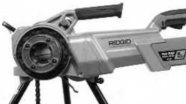
11-сурет – 760 FXP электр жетегінің тиісті бағдары
