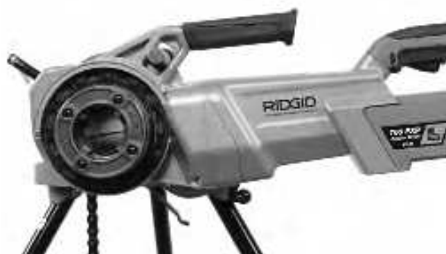
Рис. 11 - Правильная ориентация силового привода 760 FXP
