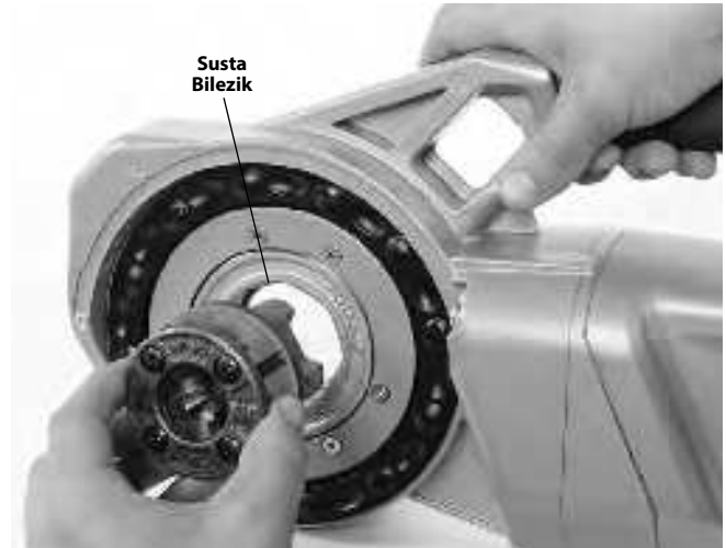
Şekil 8 – 1 1/4" veya Daha Küçük 11-R Pafta Kafalarının (yalnızca 760 FXP 11-R) takılması
