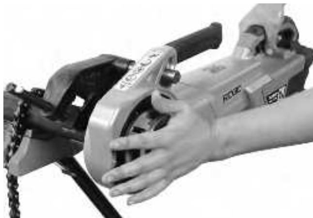
Фигура 13А – Започване на резбване с използване на капак на главата за матрици
