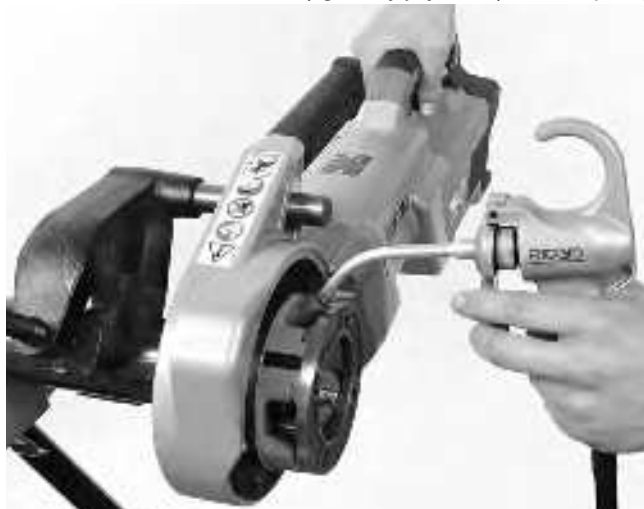
Rysunek 14 - Gwintowanie rury
