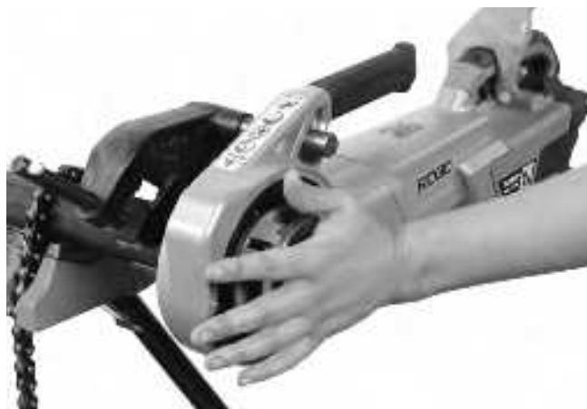
Figur 13A – Påbegyndelse af gevindskæringen ved hjælp af skærehovedets dækplade
