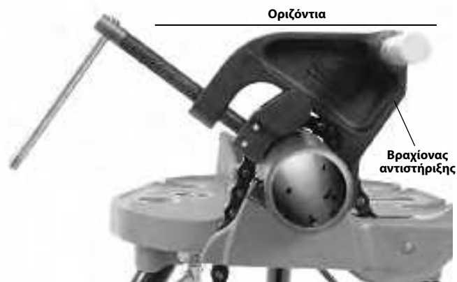
Εικόνα 10Α – Τοποθέτηση του βραχίονα αντιστήριξης
