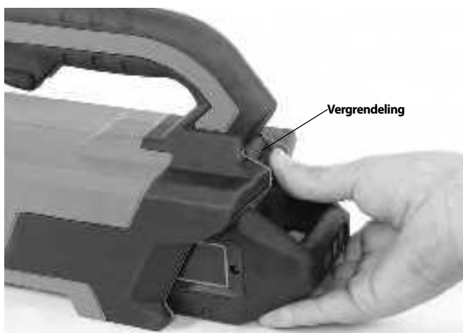
Afbeelding 12 – Vergrendeling van de batterij
