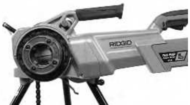
11. ábra – A 760 FXP motoros hajtóegység helyes tájolása
