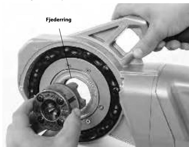
Figur 8 – Montering af 11-R skærehoveder, 1 1/4" eller derunder (kun 760 FXP 11-R)
