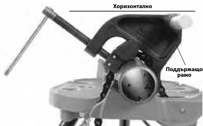
Фигура 10А – Позициониране на поддържащо рамо Подравнено
