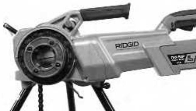
Figur 11 – Korrekt inriktning av 760 FXP-drivenheten
