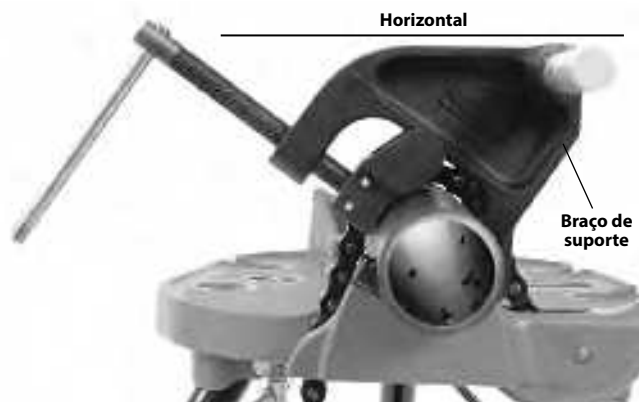
Figura 10A – Posicionamento do Braço de Suporte
