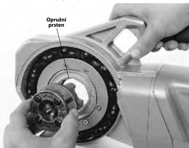
Slika 8 – Postavljanje 1 1/4" ili manjih narezni glava 11-R (samo 760 FXP 11-R)
