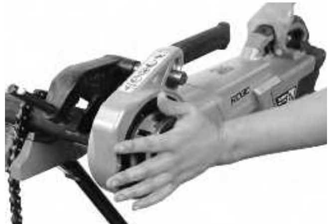
Figure 13A – Entame de filetage à l'aide du couvercle de tête de filière
