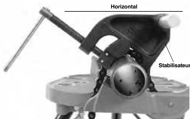
Figure 10A – Positionnement du stabilisateur
