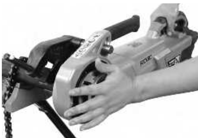
Slika 13A – Započinjanje navoja pomoću poklopca narezne glave
