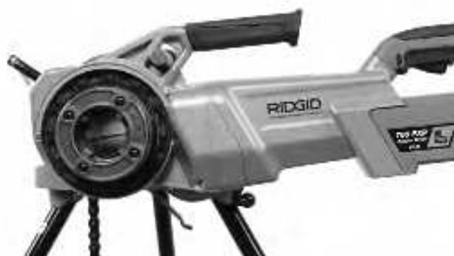
Figura 11 – Orientação correta do Propulsor 760 FXP
