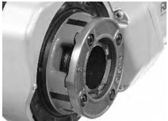
15-сурет – Кескіштер жиегімен бір деңгейдегі құбыр
