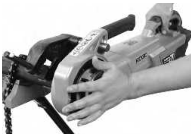
Figur 13A – Starta gängning med gänghuvudets täckplatta
