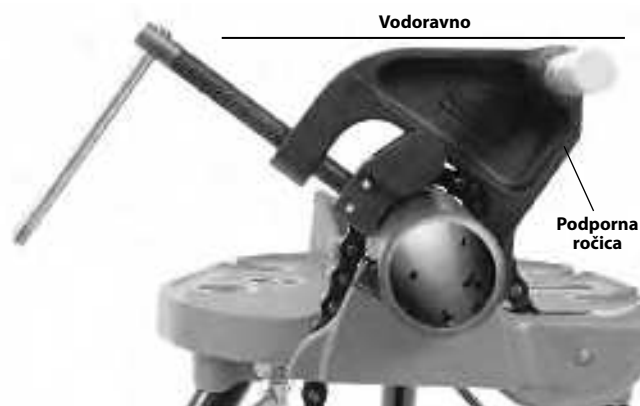
Slika 10A – Nameščanje podporne roke
