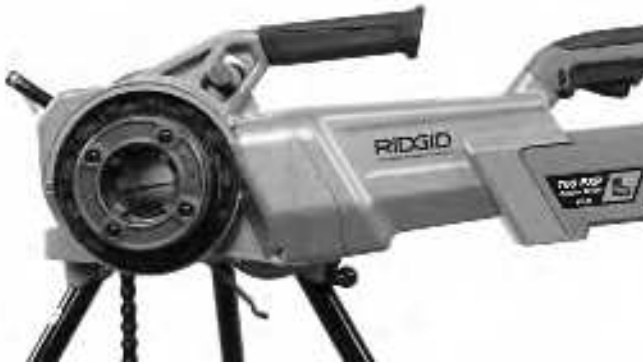
Εικόνα 11 – Σωστός προσανατολισμός του Ηλεκτρικού βιδολόγου 760 FXP
