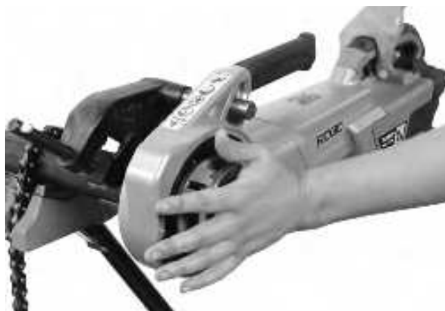
Рис. 13А - Начало нарезания резьбы с помощью крышки резьбонарезной головки
