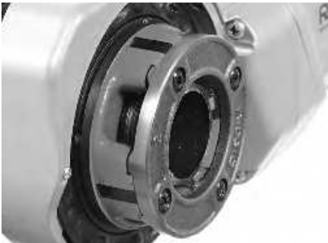
Rysunek 15 – Koniec rury wyrównany z krawędzią noży
