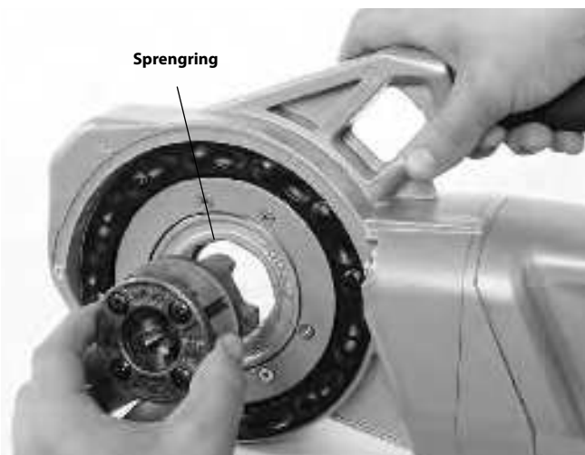
Figur 8 – Montering av 1¼" eller mindre 11-R gjengehoder (bare 760 FXP 11-R)
