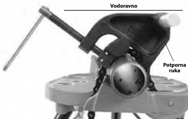
Slika 10A – Postavljanje potporne ruke
