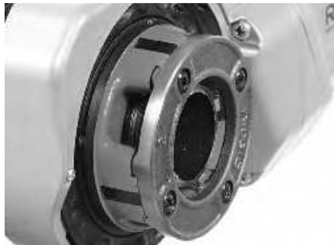
Рис. 15 – Торец трубы вровень с кромкой резьбонарезных гребенок
