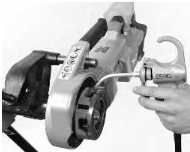
Figur 14 – Gjenging av rør
