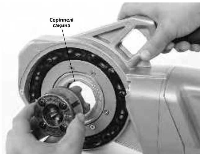
8-сурет – 1¼ дюймдік не кіші 11-R бастиектерін орнату (тек 760 FXP 11-R)
