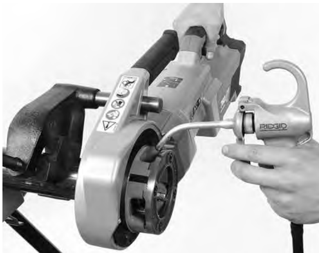
Рис. 14 – Нарезание резьбы на трубе
