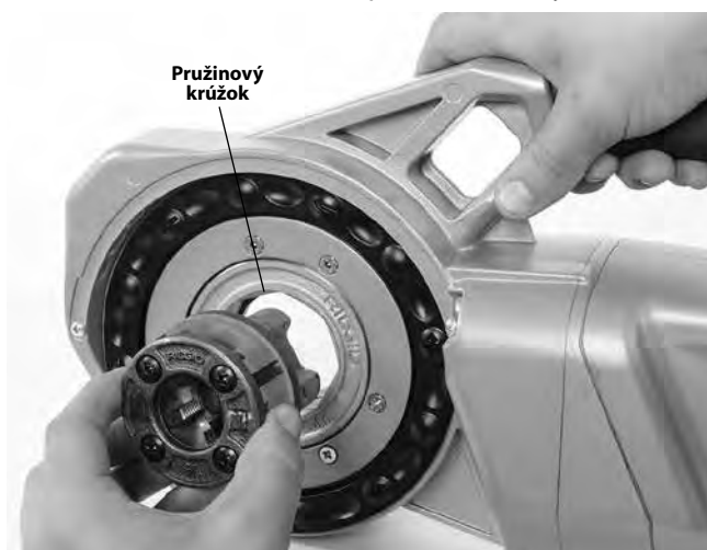
Obrázok 8 – Inštalácia 1 1/4" alebo menších závitorezných hláv 11-R (len 760 FXP 11-R)
