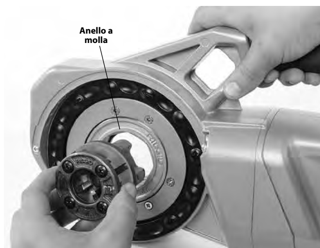
Figura 8 – Installazione di Teste di filettatura 11-R 1¼" o più piccole (solo 760 FXP 11-R)
