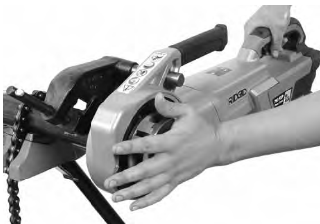
Figur 13A – Starta gängning med gänghuvudets täckplatta
