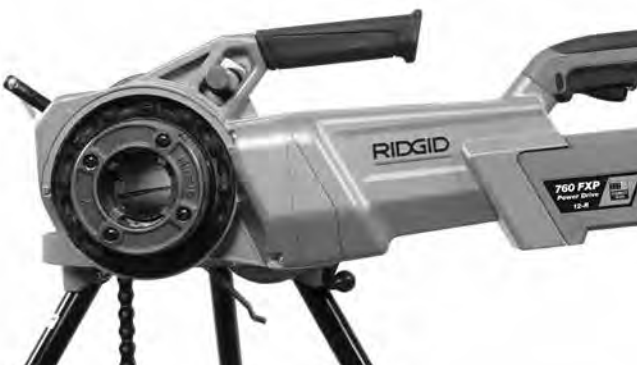
Kuva 11 – 760 FXP -käyttölaitteen oikea suunta
