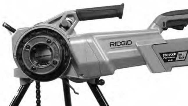
Slika 11 – Pravilno usmjerenje električne nareznice 760 FXP
