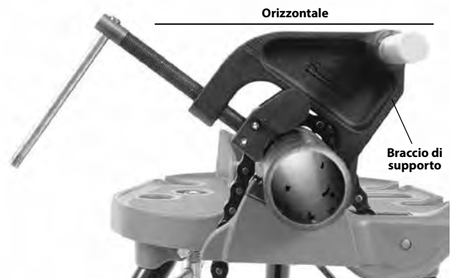
Figura 10A – Posizionamento del braccio di supporto
