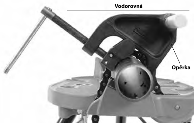
Obrázek 10A – Umístění opěrky
