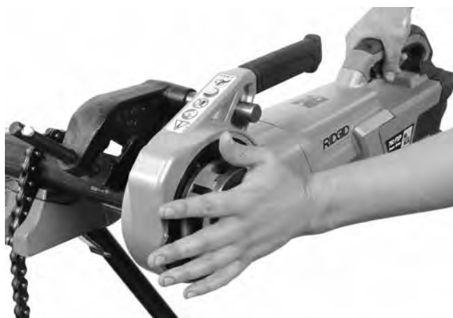
Obrázek 13A – Spuštění řezání závitů pomocí krycího plátu závitorezné hlavy
