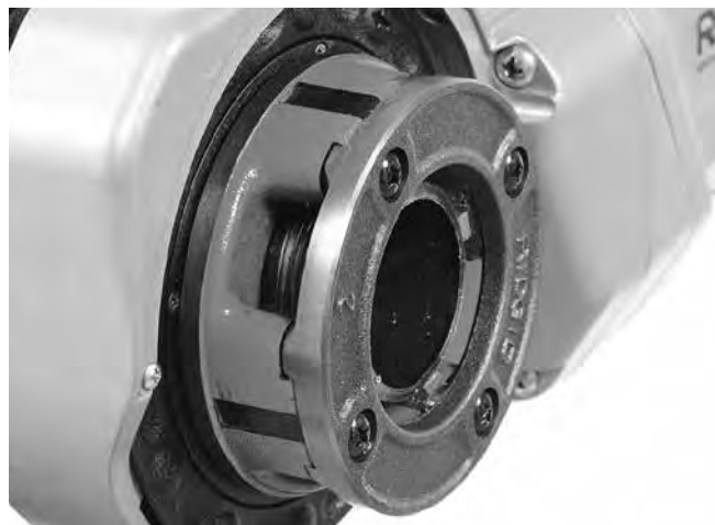
Obrázok 15 – Rúra zarovnaná s hranou závitnice
