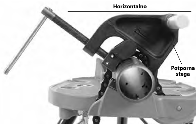
Slika 10A – Pozicioniranje potporne stega
