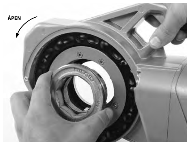
Figur 7 – Montering av adapter
