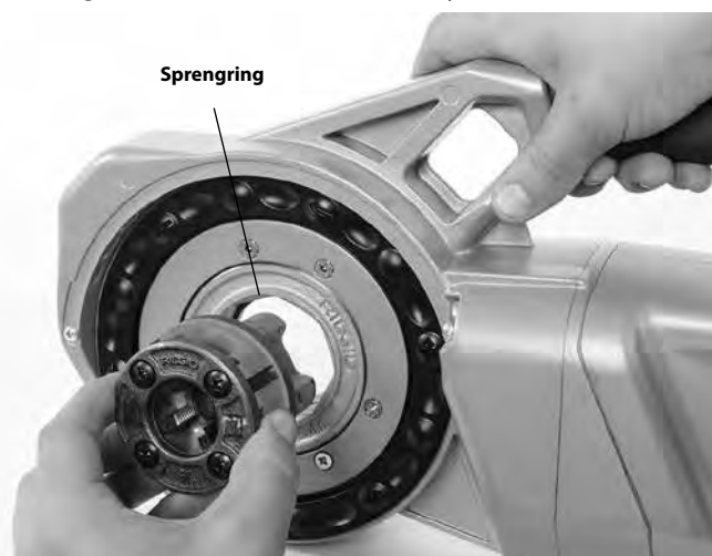
Figur 8 – Montering av 1 1/4" eller mindre 11-R gjengehoder (bare 760 FXP 11-R)
