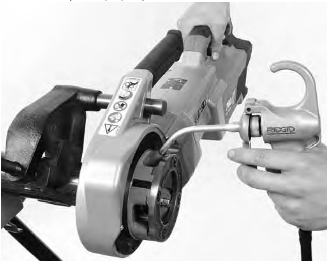
Şekil 14 – Boruya Diş Açılması
