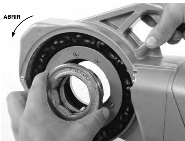
Figura 7 – Montaje del adaptador
