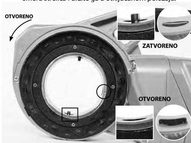
Slika 6A – Mehанизam za držanje (760 FXP 12-R)
