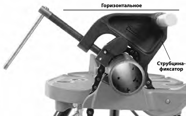
Рис. 10А - Позиционирование трубины-фиксатора
