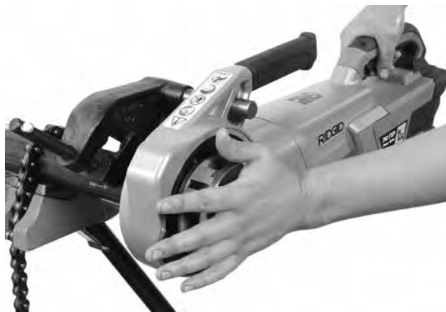
Фигура 13А – Започване на резбване с използване на капака на главата за матрици
