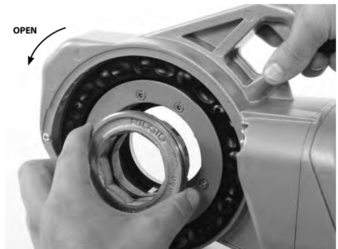
Afbeelding 7 – De adapter monteren
