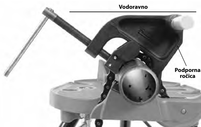
Slika 10A – Nameščanje podporne roke
