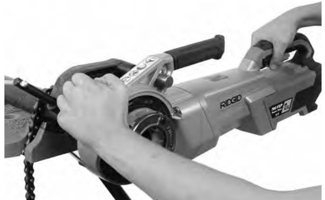
Abbildung 13B - Gewindeschneiden mithilfe des Druckkissens starten
