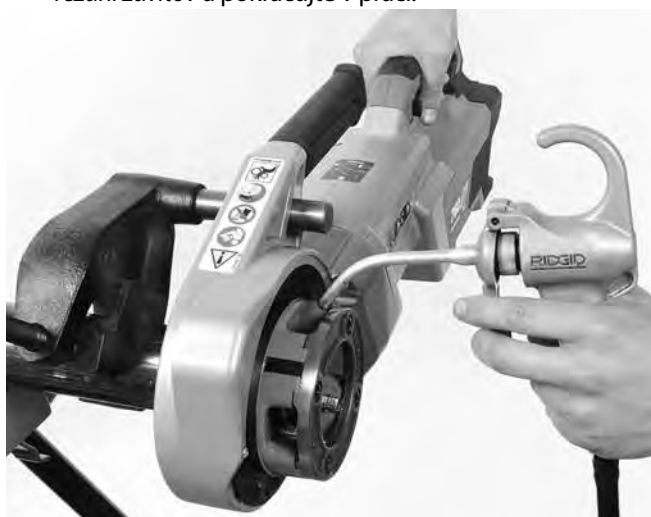
Obrázok 14 – Rezanie závitov na rúru
