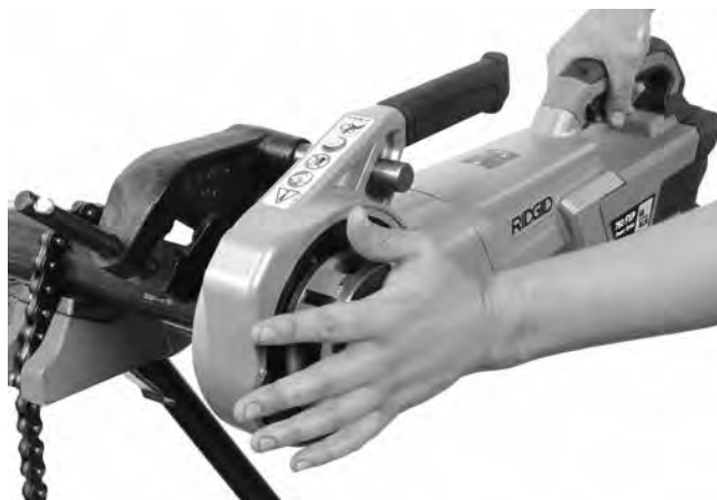
Obrázok 13A – Spustenie rezania závitov pomocou krycej dosky závitoreznej hlavy
