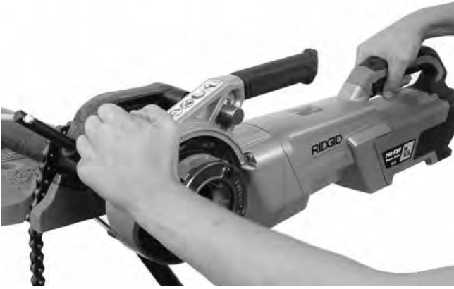
Şekil 13B – İtme Plakası Kullanarak Diş Açmanın Başlatılması
