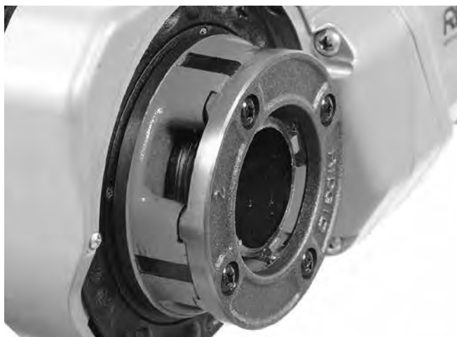
Slika 15 – Cev poravnata sa ivicom nareznice
