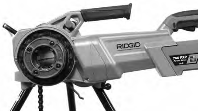
11. ábra – A 760 FXP motoros hajtóegység helyes tájolása
