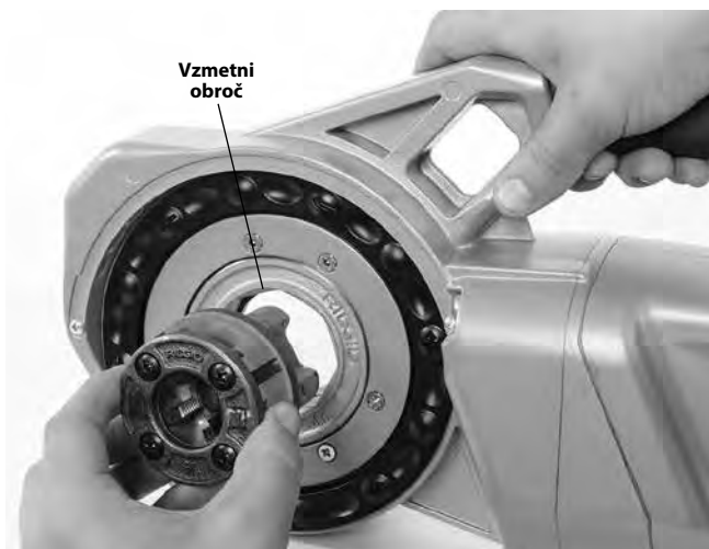
Slika 8 – Nameščanje 1 1/4" ali manjših 11-R glav navojnega rezalnika (samo 760 FXP 11-R)
