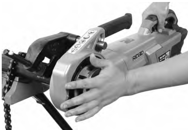
Slika 13A – Pokretanje narezivanja s pomoću pokrivne ploče narezne glave
