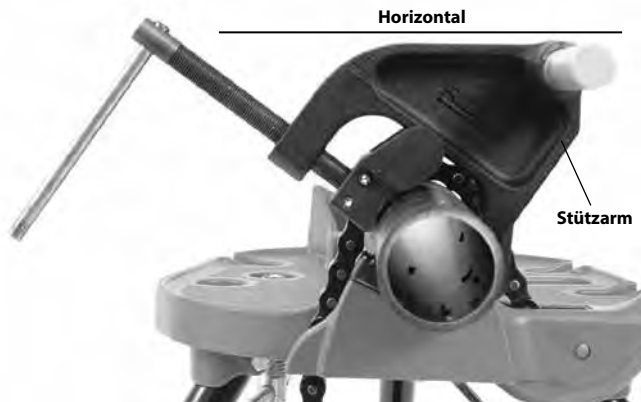
Abbildung 10A - Positionierung des Stützarms
