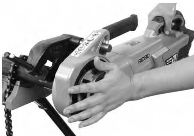
Figura 13A – Início da Rosca com a Placa de Cobertura da Cabeça de Roscar
