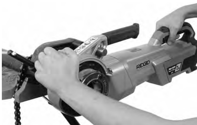
Afbeelding 13B – Met draadsnijden beginnen met behulp van de drukplaat
