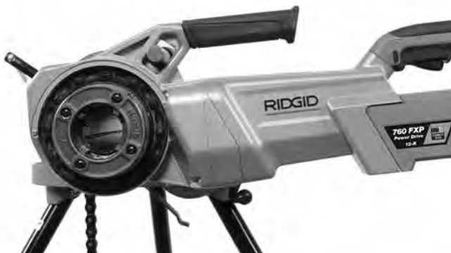
Abbildung 11 - Richtige Ausrichtung des 760 FXP Kraftantriebs
