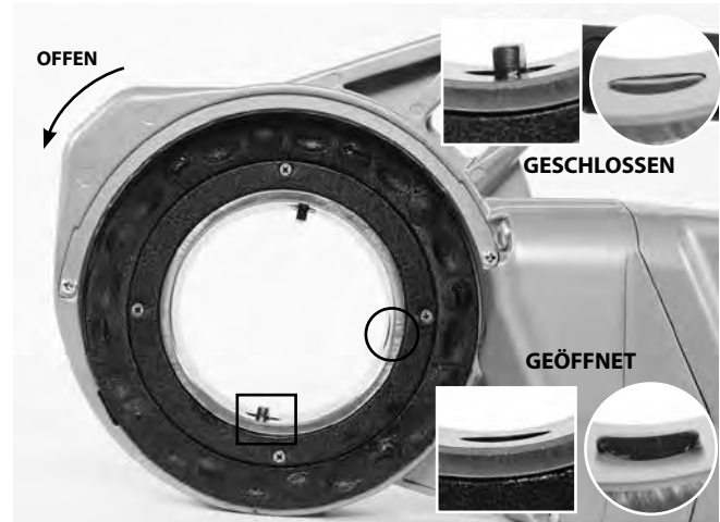
Abbildung 6A - Haltemechanismus (760 FXP 12-R)
