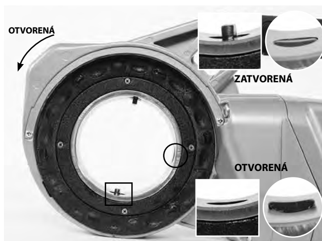
Obrázok 6A – Zaisťovací mechanizmus (760 FXP 12-R)
