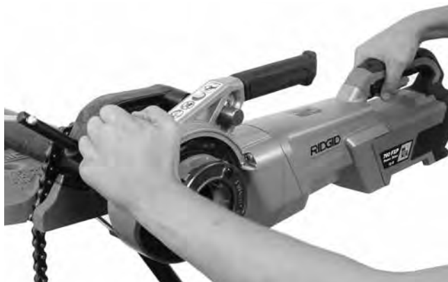
Rysunek 13B - Rozpoczęcie nacinania gwintu przy użyciu przycisku płytkowego
