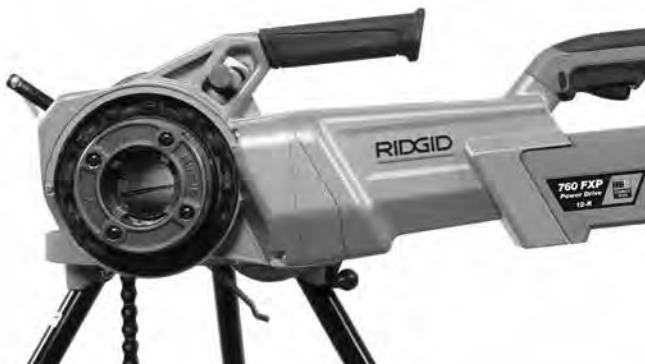
Slika 11 - Pravilna usmerjenost električnega pogona 760 FXP
