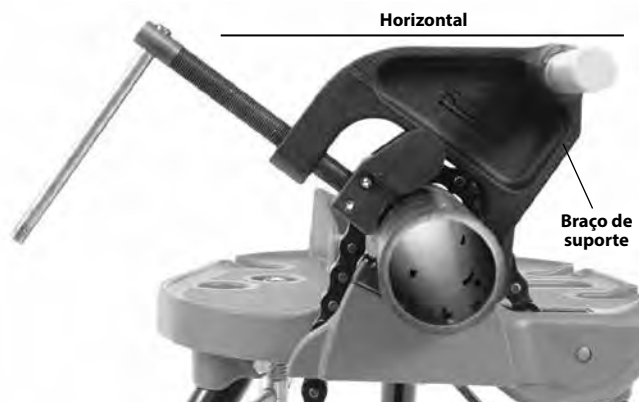
Figura 10A – Posicionamento do Braço de Suporte
