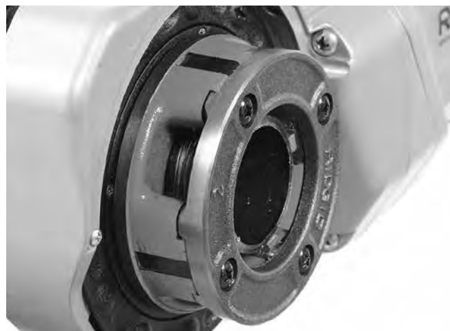
Figura 15 – Țeava la nivel cu marginea filierelor
