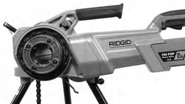
Figura 11 – Orientação correta do Propulsor 760 FXP
