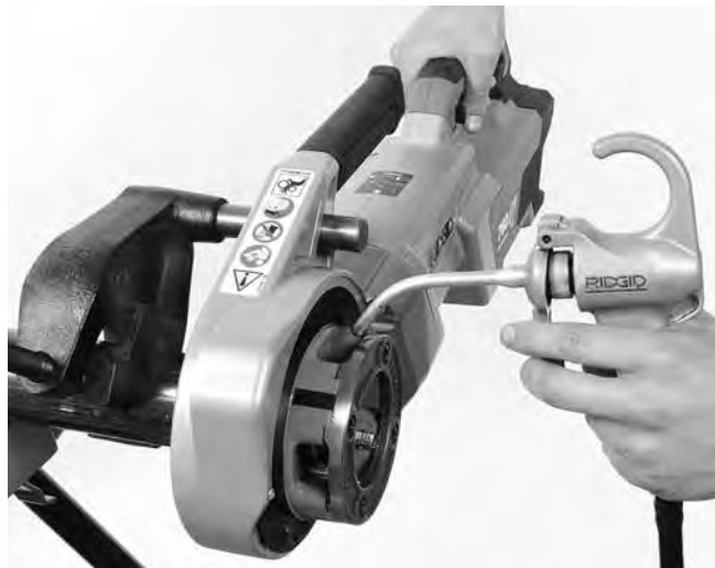
Figur 14 – Gjenging av rør
