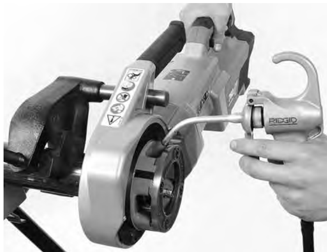
Figura 14 – Roscado de un tubo
