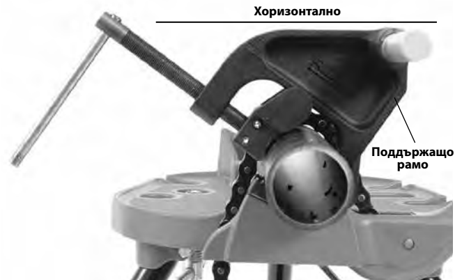
Фигура 10А – Позициониране на поддържащо рамо Подравнено
