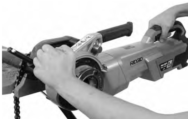
Slika 13B – Pokretanje narezivanja s pomoću pritisne ploče
