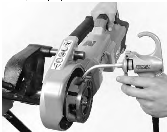
Obrázek 14 – řezání závitu na trubce
