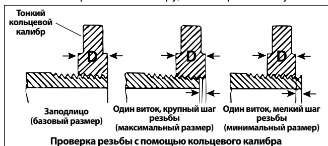
Рис. 16 – Проверка размера резьбы
