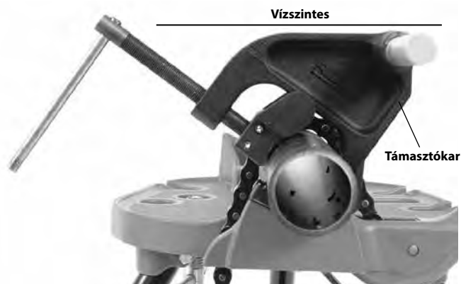
10A ábra – A kitámasztó kar elhelyezése
