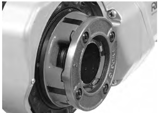
Figura 15 – Tubo allineato al bordo degli stampi
