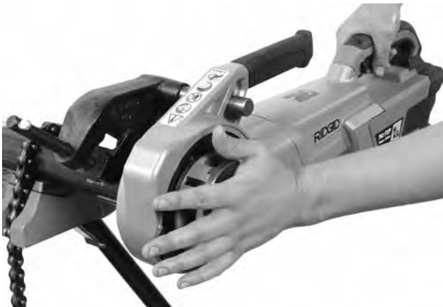
Abbildung 13A - Gewindeschneiden mithilfe der Schneidkopfabdeckplatte starten
