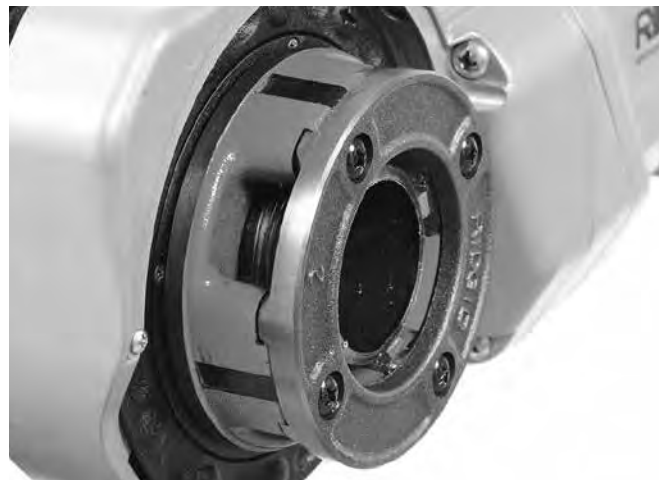
15-сурет – Кескіштер жиегімен бір деңгейдегі құбыр
