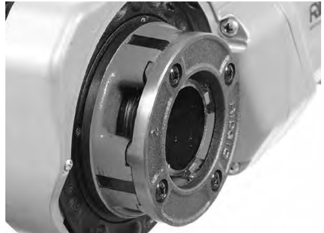
Şekil 15 – Paftanın Kenarıyla Hizalı Boru
