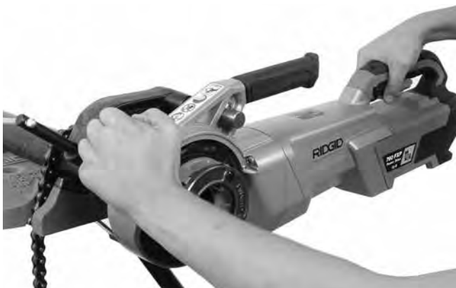
13B ábra – Menetvágás kezdése a nyomópárna használatával
