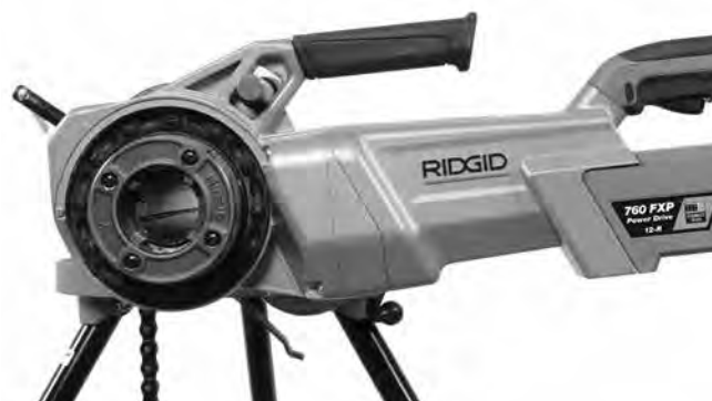
Obrázok 11 – Správna orientácia elektrického pohonu 760 FXP
