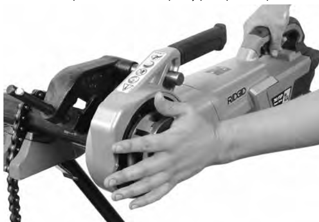
Figura 13A – Pornirea filetării prin utilizarea capacului capului-filieră
