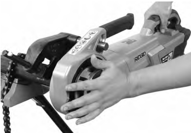
Figur 13A – Starte gjengingen med gjengehodets dekkplate
