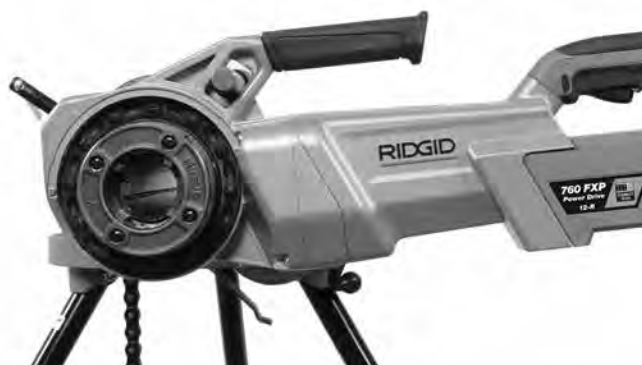
Рис. 11 - Правильная ориентация силового привода 760 FXP
