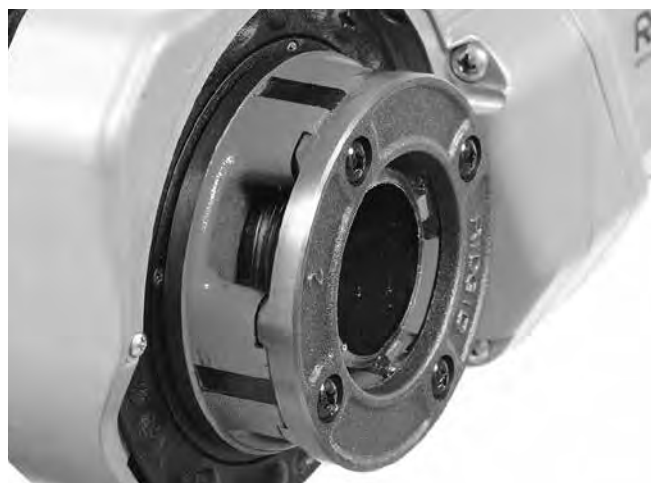
Figur 15 – Röret i linje med gängbackarnas kant
