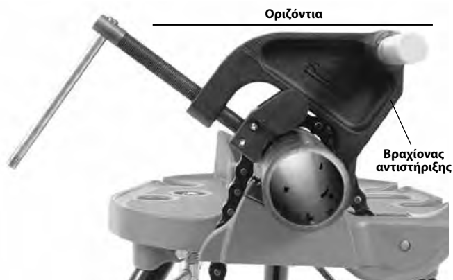
Εικόνα 10Α – Τοποθέτηση του βραχίονα αντιστήριξης
