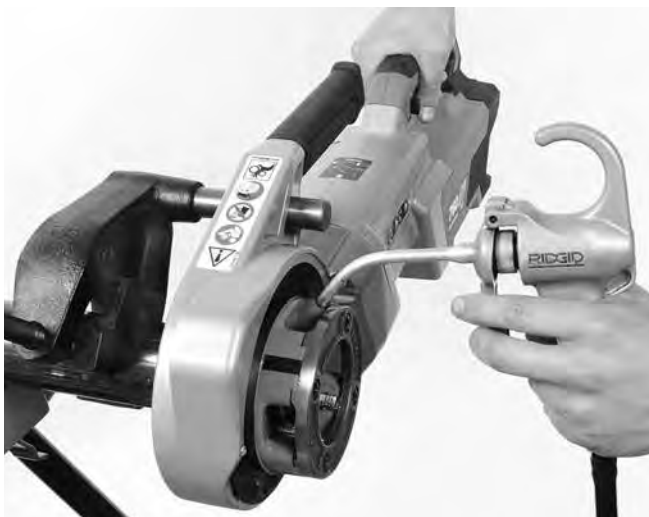
14. ábra – Menetvágás csőre
