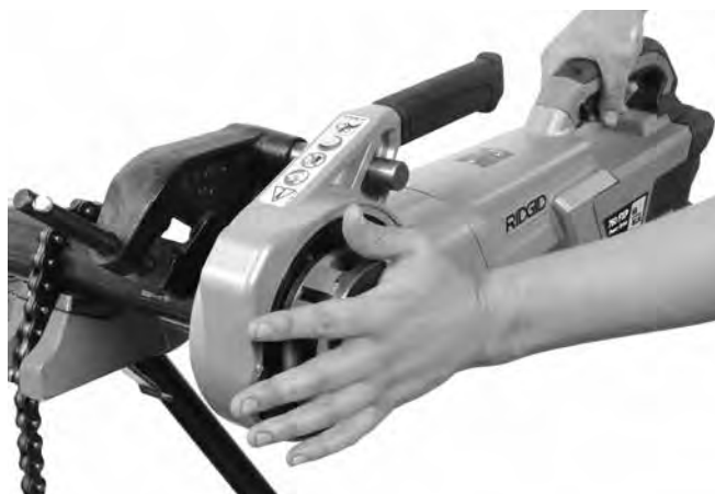
Rysunek 13A - Nacinanie początku gwintu przy użyciu płyty pokryw głowicy gwinciarskiej
