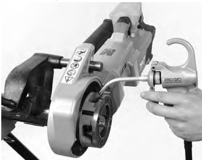
Figur 14 – Gevindskæring af rør
