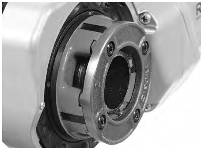
Figur 15 – Rør på linje med kanten av gjengebakkene
