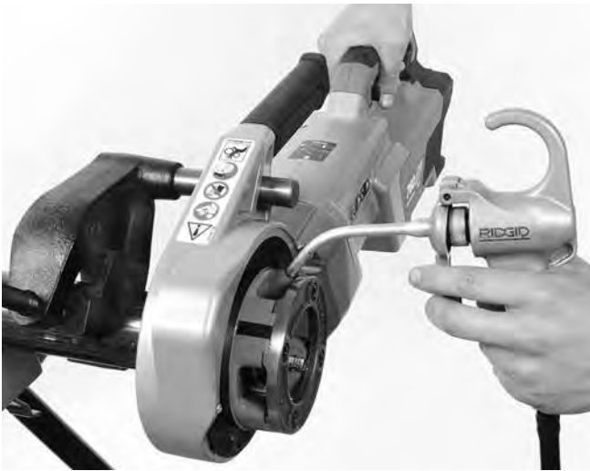
Abbildung 14 – Gewindeschneiden in Rohr
