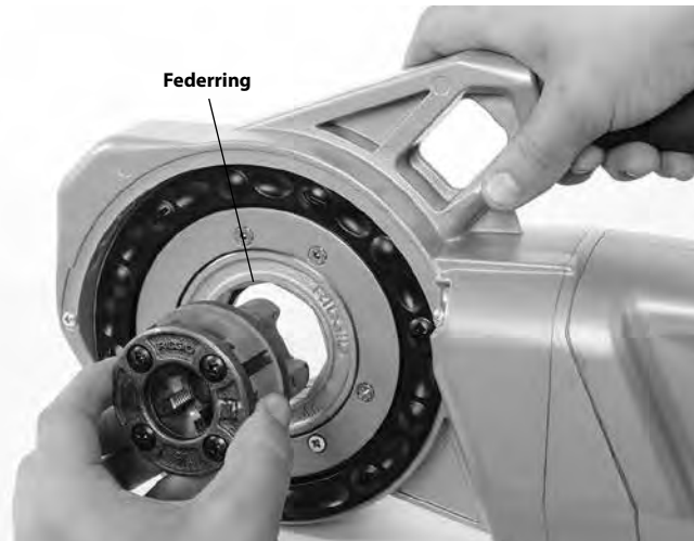
Abbildung 8 – Einbau von 1 1/4" oder kleineren 11-R Schneidköpfen (nur 760 FXP 11-R)
