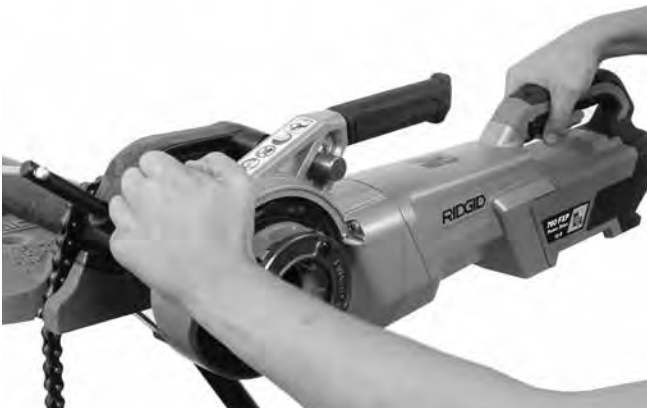
Figur 13B – Starte gjengingen med skyveputen
