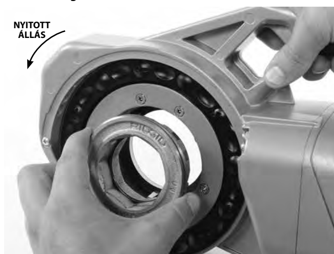
7. ábra – Adapter felszerelése
