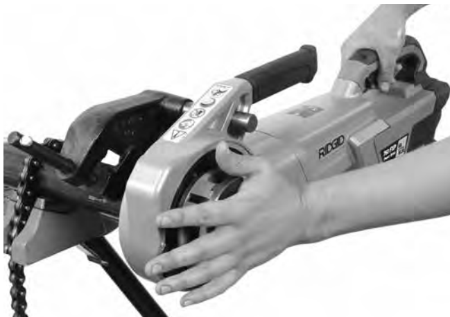
Figura 13 A – Iniciar el roscado al presionar la tapa del cabezal roscador
