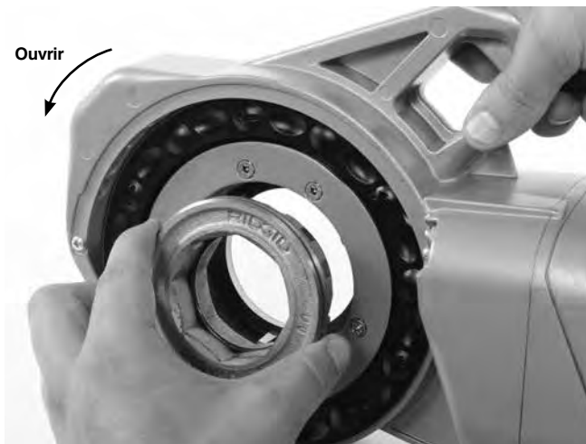
Figure 7 – Installation de l'adaptateur
