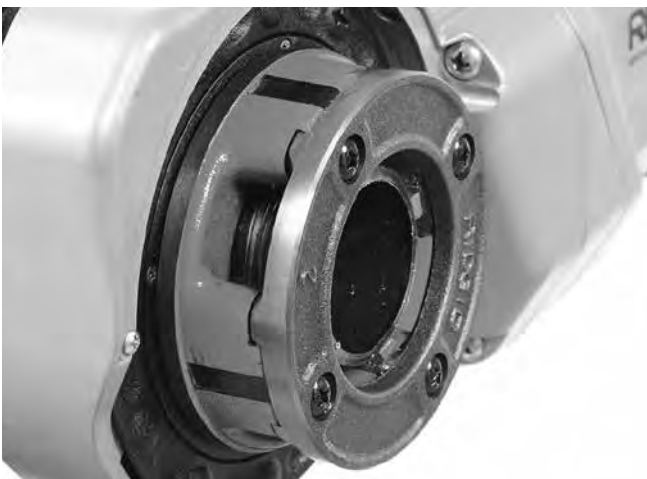
Abbildung 15 – Rohr fluchtet mit Kante der Schneidbacken
