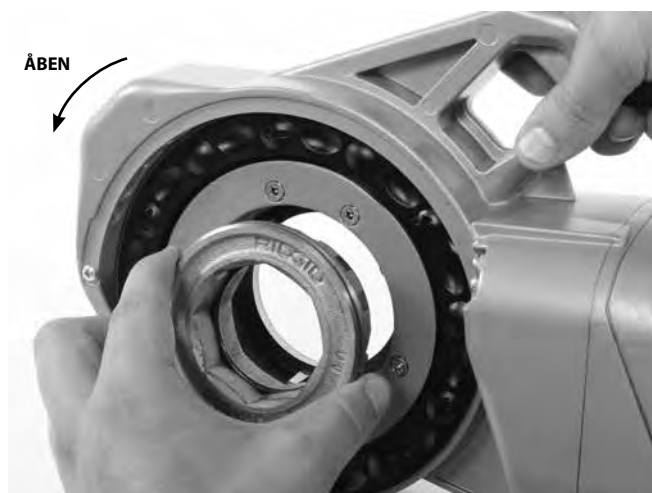
Figur 7 – Montering af adapter
