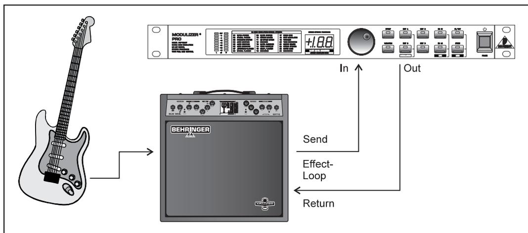
Abb. 3.3: MODULIZER PRO-Verkabelung mit einem Gitarrenamp (Send/Return-Mono)
