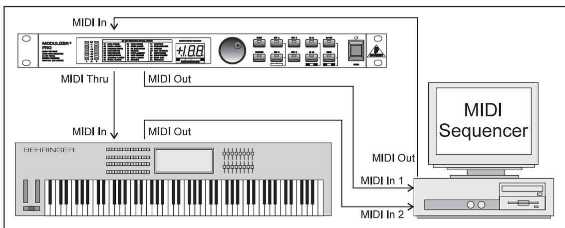
Abb. 3.4: MODULIZER PRO in MIDI-Verbindung mit einem Sequencer (Computer) und einem Keyboard
