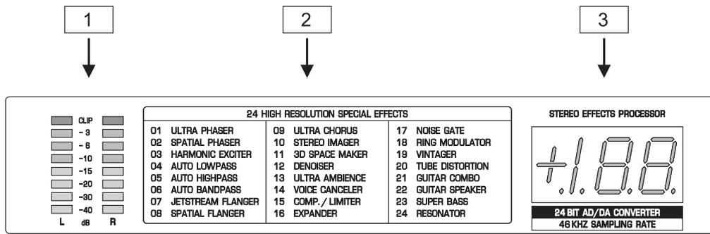
Abb. 1.2: Die Anzeigensektion des MODULIZER PRO
