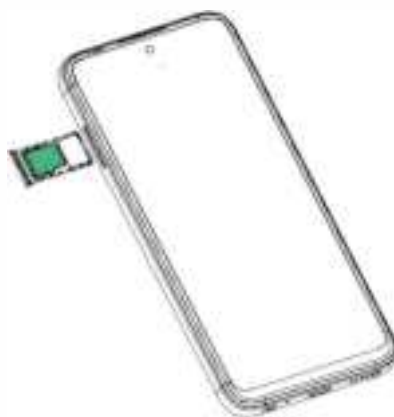
EN Insert Micro SD card
