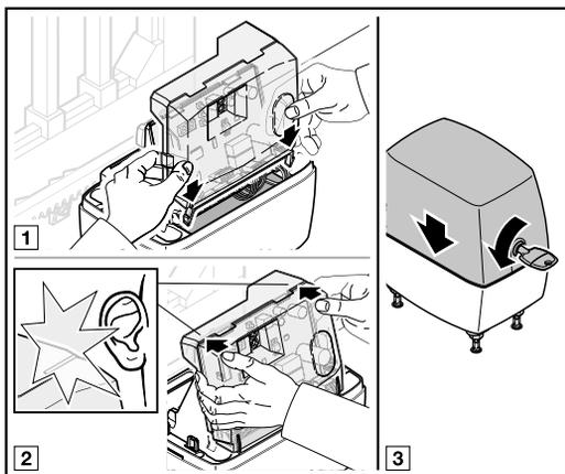
1. Setzen Sie die transparente Abdeckung auf die Steuerungsplatine.
