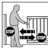
1. Halten Sie das Tor, während es **zufährt** mit beiden Händen an. Die Toranlage muss anhalten und den Sicherheitsrücklauf einleiten.
