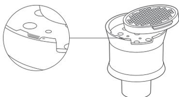
3. Richten Sie die Zyklon-Baugruppe mit dem Staubsauger aus, wie in der Abbildung gezeigt und drehen Sie die Zyklon-Baugruppe in Position, indem Sie sie im Uhrzeigersinn drehen.
