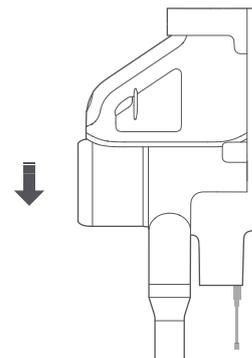
Drücken Sie den Staubsauger in der Aufladestation herunter, um ihn zu laden
