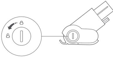
2. Nach dem Entfernen der Verriegelung, entfernen Sie die Rolle vom Bettbürste.
