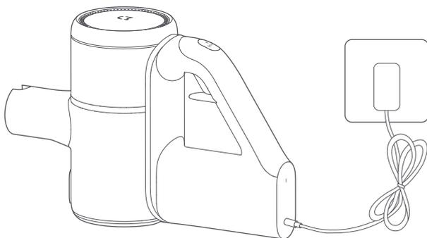
Laden des Staubsaugers mit Netzteil
