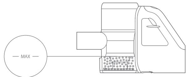
2. Drücken Sie zum Leeren des Staubbehälters den Schalter auf dem Staubbehälter in Pfeilrichtung, um die Bodenabdeckung zu öffnen und leeren Sie ihn in einen Mülleimer.
