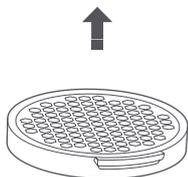
2. Setzen Sie den Filter oben auf der Zyklon-Baugruppe ein und drücken Sie ihn vorsichtig in Position, während Sie den Sicherheits-Clip links von der Kerbe zur Seite drücken.
