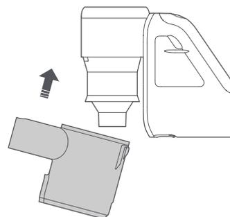
5. Drücken Sie den Staubbehälter vorsichtig in die in der Abbildung gezeigte Richtung bis Sie ein Klicken hören, das Ihnen zeigt, dass der Behälter nun sicher befestigt ist.
