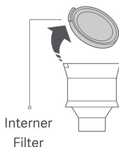
4. Reinigen Sie den Filter und die Zyklon-Baugruppe, bis sie sauber sind. Wringen Sie den Filter nach dem Reinigen aus.
