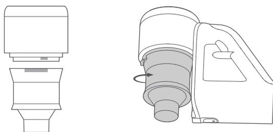
4. Kippen Sie den Staubbehälter leicht, wenn Sie ihn in den Staub-sauger einsetzen.
