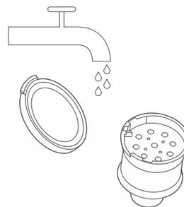
5. Um die Zyklon-Baugruppe und den Filter vollständig zu trocknen, legen Sie sie nach dem Reinigen für mindestens 24 Stunden an einen belüfteten, kühlen Ort.
