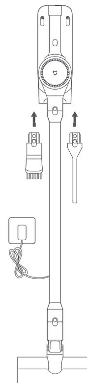
Laden des Staubsaugers mit der Aufladestation
