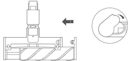
6. Drehen Sie die Verriegelung um 90° im Uhrzeigersinn in die verriegelte Position, um die Rolle zu sichern.
