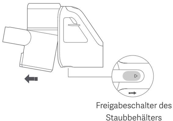
2. Drehen Sie die Zyklon-Baugruppe in die Richtung wie in der Abbildung dargestellt.
