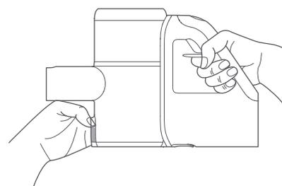
3. Während Sie auf den Schalter neben dem Staubbehälter in Pfeilrichtung drücken, ziehen Sie den Behälter vom Staubsauger weg, um ihn mit Wasser reinigen zu können.
