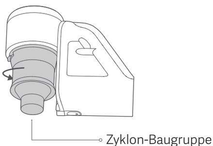
3. Entfernen Sie den internen Filter von der Zyklon-Baugruppe.
