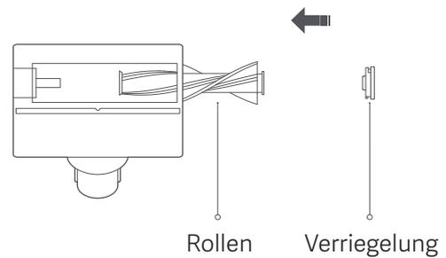
6. Wenn die Seitenverriegelung des Bürstenkopfes in Ihre Richtung zeigt, verwenden Sie eine Münze und drehen Sie die Verriegelung im Uhrzeigersinn in die verriegelte Position, während Sie die Rolle in Position halten.
