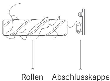
4. Setzen Sie die Abschlusskappe nach dem Reinigen wieder auf die Rolle.
