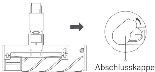
3. Trennen Sie die Abschlusskappe von der Rolle und entfernen Sie alle Haare, die sich um die Rolle und die Abschlusskappe gewickelt haben.
