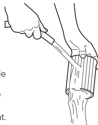
e. Sortez le joint du réceptacle ⑯ et lubrifiez-le généreusement avec de la gelée de pétrole.
