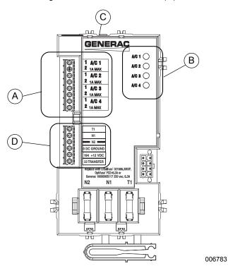
Figure 2-2. Smart A/C Module (SACM)
