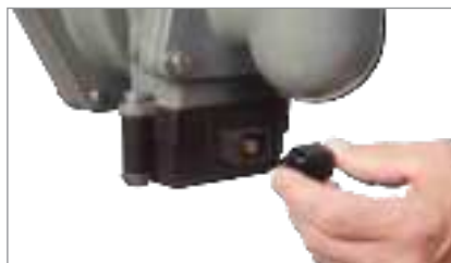
4. Retirez le couvercle antipoussière du capteur.
