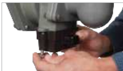
2. Pour chaque côté du capteur, placez la rondelle sur la tête du boulon, vissez le boulon à partir du bas et serrez l'écrou à la main sur le boulon.
