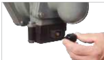
4. Retire la cubierta antipolvo del sensor.
