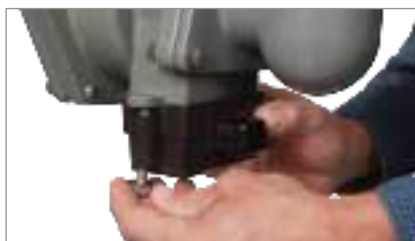
2. Para cada lado del sensor, coloque la arandela en la cabeza del perno, enrosque el perno desde la parte inferior y apriete a mano la tuerca al perno.
