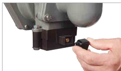
4. Retirez le couvercle antipoussière du capteur.
