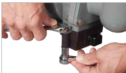
3. Utilisez les deux clés pour serrer le matériel fixant le capteur à la vanne.
