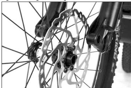
Sur les roues avant du ROTWILD e-MTB sont employés des essieux à vis. Lors de la mise en place du moyeu de roue avant, veillez à ce que le moyeu soit bien en place dans les extrémités de dégagement et que le disque de frein soit bien centré dans l'étrier de frein.
