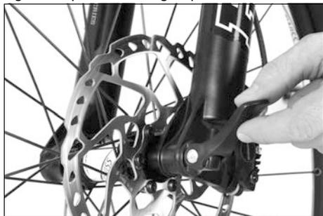
Fig. 54: Montage du vissage d'essieu / roue avant
