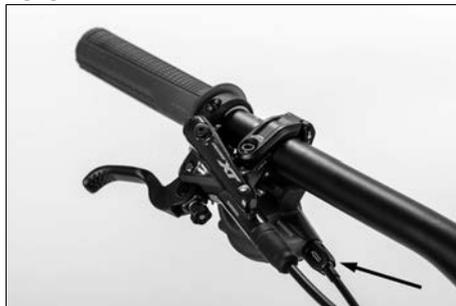
Fig. 26: Vis de butée de fin de course
