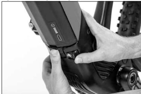
Retirez la goupille de sécurité. Libérez la batterie de transmission et maintenez-la d'une main pour éviter qu'elle ne tombe. De l'autre main, abaissez la fermeture de la batterie de transmission et faites descendre la batterie.
