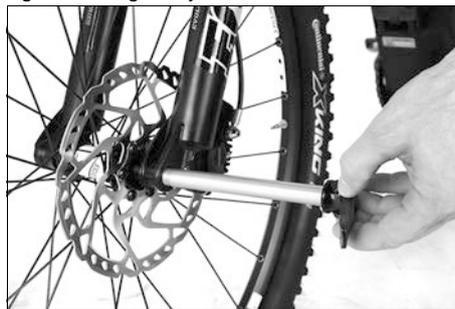
Dépliez le dispositif de serrage rapide sur l'essieu vissable et poussez l'essieu légèrement graissé à travers le moyeu jusqu'à ce que le filetage prenne dans l'extrémité de dégagement. Tournez l'axe à fond et établissez la précontrainte en rabattant le levier de serrage de 90° vers le haut.
