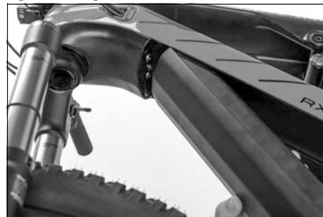
Pour terminer, bloquez la batterie de transmission avec la goupille de sécurité dans le tube inférieur. Pour cela, levez légèrement la fermeture de la batterie de transmission et installez la goupille de sécurité dans l'ouverture prévue à cet effet.
