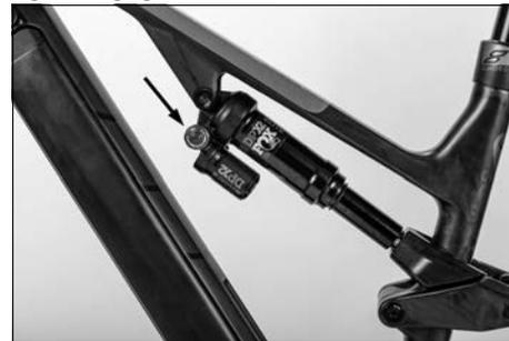
Pour le réglage correct, à la première étape, il faut tourner la molette de réglage rouge jusqu'à la butée dans le sens inverse des aiguilles d'une montre. Ensuite, la vis de réglage est tournée par petites étapes/clics dans le sens des aiguilles d'une montre jusqu'à ce que le réglage d'amortisseur correct soit configuré.
