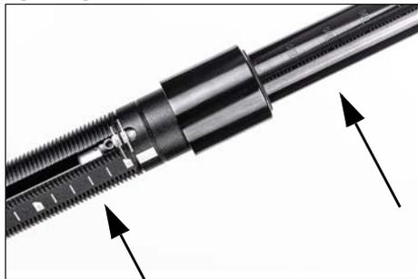
3. Ouvrez le serrage de selle avec un six pans creux de 4 mm et retirez la tige. Comme le mécanisme de déclenchement du réglage en hauteur est serré dans le cadre, il n'est pas sorti.
