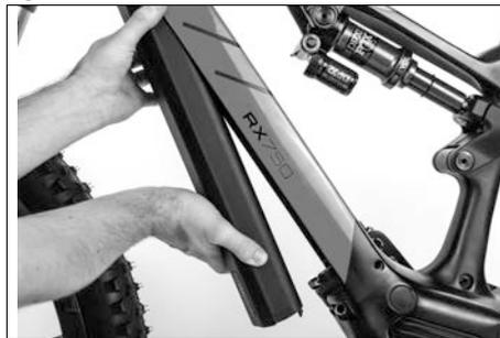
La batterie de transmission peut maintenant être ôtée de l'e-MTB par le bas.
