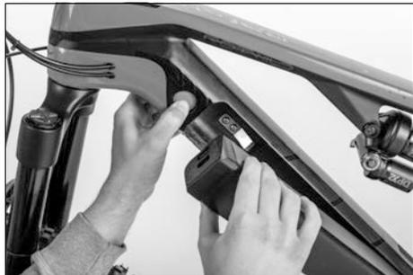
Actionnez à nouveau le mécanisme de retrait pour retirer la batterie de transmission du tube inférieur vers le côté.
