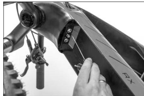
Après avoir adapté la précontrainte de la batterie de transmission, remontez les deux vis à tête fraisée extérieures ainsi que la vis à tête cylindrique centrale avec les couples prescrits (voir «Couples de serrage recommandés» à la page 81).
