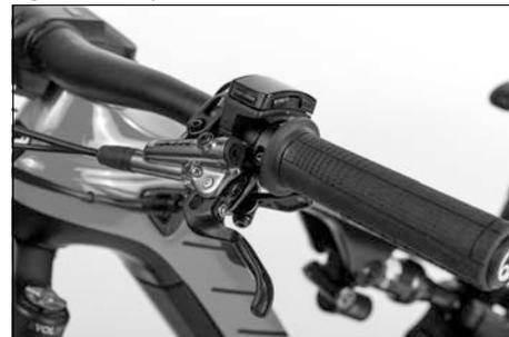
Fig. 16: Interrupteur Marche/arrêt (375)
