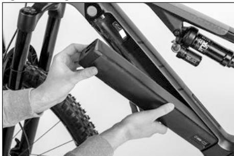
Lorsque la batterie s'est insérée dans le support inférieur du tube inférieur, elle peut être pivotée latéralement dans le tube inférieur. La batterie de transmission doit s'enclencher de manière
