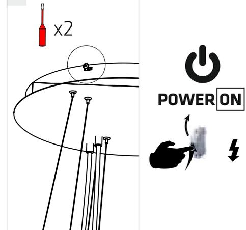
1) Produkt przeznaczony jest do montażu na równych i gładkich powierzchniach. Dopiero jeżeli powierzchnia sufitu jest płaska przy wymiarach nie większych niż 3000 mm, należy wyznaczyć linię 3. W przypadku większych odchyśleń powierzchni sufitów konieczna jest konsultacja z producentem - nie należy montować (zakładać) akcesoriów do montażu na nierównych powierzchniach.
