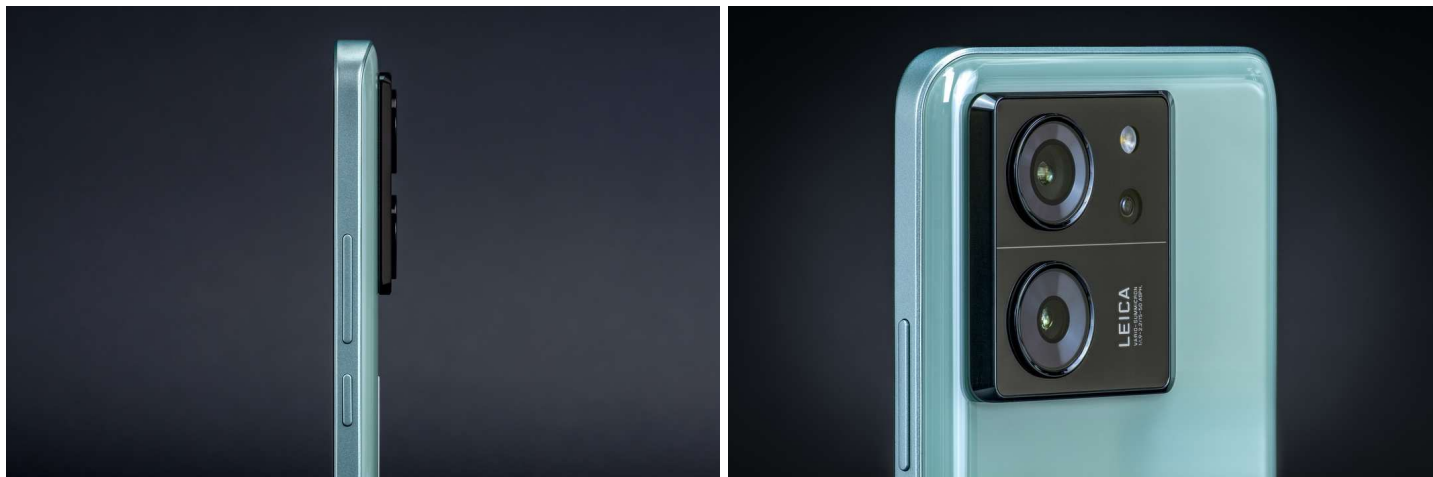
Z całą pewnością najbardziej charakterystyczną cechą bryły smartfona jest tylna wyspa z aparatami, wpisana prostokąt 43,1 mm (dł.) x 42,6 mm (szer.), o wysokości 2,5 mm + dodatkowy rant obiektywów 1,5 mm co daje łączną wysokość aż 4 mm. Wyspę skrywającą obiektywy wykonano z tafli szkła hartowanego.
