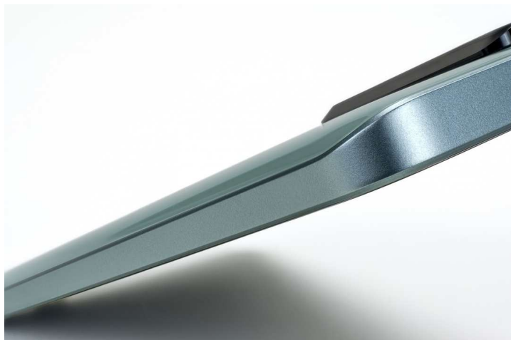
Ramkę obudowy modelu 13T wykonano z tworzywa sztucznego. Tworzywo jest dobrej jakości, nie ugina się, cechuje go wysoka sztywność i znakomite wykończenie.
