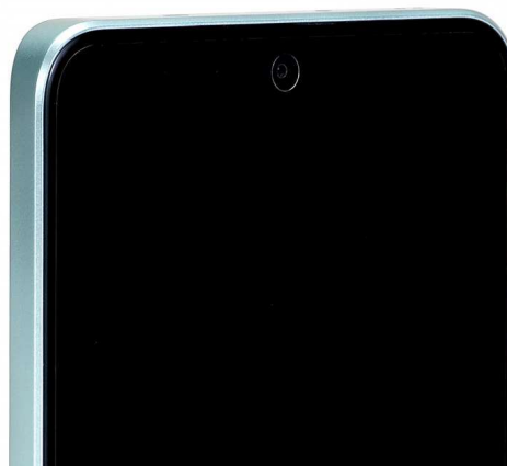
Ramkę obudowy modelu 13T wykonano z tworzywa sztucznego. Tworzywo jest dobrej jakości, nie ugina się, cechuje go wysoka sztywność i znakomite wykończenie.
