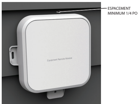
Fig. 12. Si le montage a lieu sur un bardage à clin, laisser suffisamment d'espace pour permettre le retrait du couvercle.
