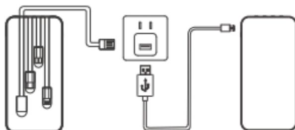
Utilice el cable Tipo C USB y cable USB AM para cargar la batería portátil.
