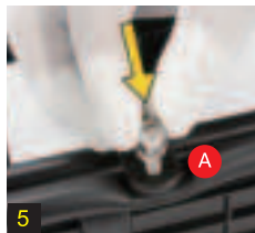
Figure 7,8 : Installez les vis A des deux côtés tour à tour, et le porte-bagages est partiellement installé
