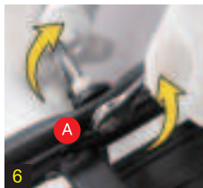
Figure 7,8 : Installez les vis A des deux côtés tour à tour, et le porte-bagages est partiellement installé
