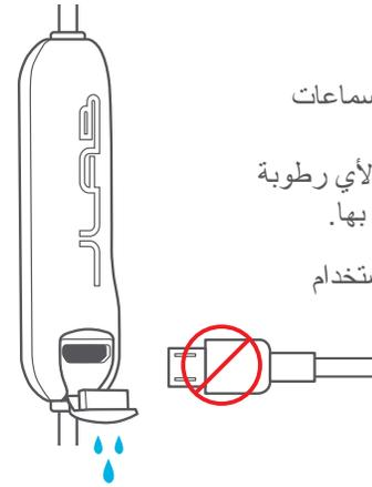
قبل الشحن، يجب تجفيف سماعات الأذن JLab BT جيدًا. يتسبب تعرّض السماعات لأي رطوبة في تلف المكونات الداخلية بها. لذا من الأفضل تجفيفها باستخدام الهواء قبل شحنها.
