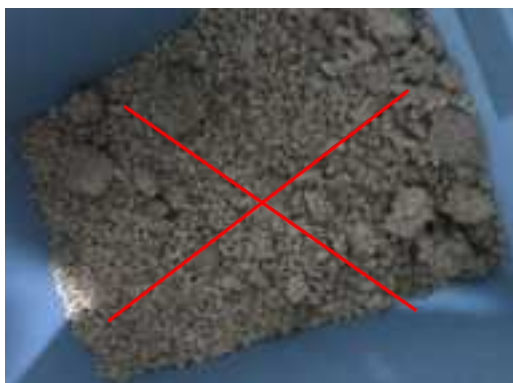
Agglomération de granulés de mauvaise qualité
