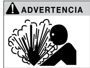
**! ADVERTENCIA** **PRESIÓN PELIGROSA:** No haga funcionar la bomba si la descarga está cerrada. Libere todos los sistemas de presión antes de trabajar en cualquier componente.
